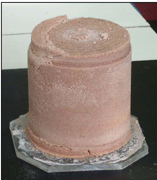
Figura 15 - Corpo-de-prova retirado da célula de compactação.
