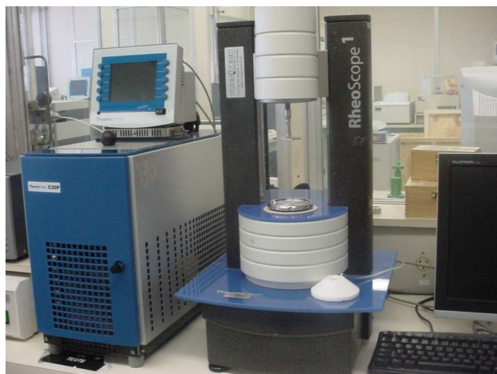
Figura 30 - Imagem do reômetro HAAK 600 (à direita) e do sistema aquecimento (à esquerda).
