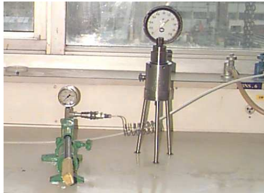
Figura 2- Unidade de rompimento do reboco.
