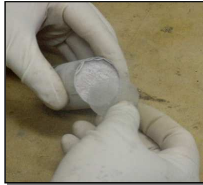
Figura 20 - Colocação das telas de aço.
