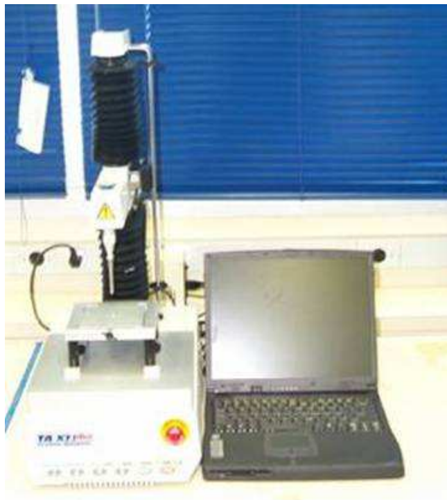
Figura 31- Imagem do Analisador de textura TA.XT2i Plus (à esquerda) acoplado a um computador (à direita), que foi usado na aquisição de dados.
