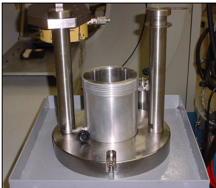
Figura 14 – Célula de compactação e o compactador.
