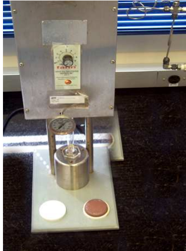
Figura 24 – Esquema de filtração HPHT.
