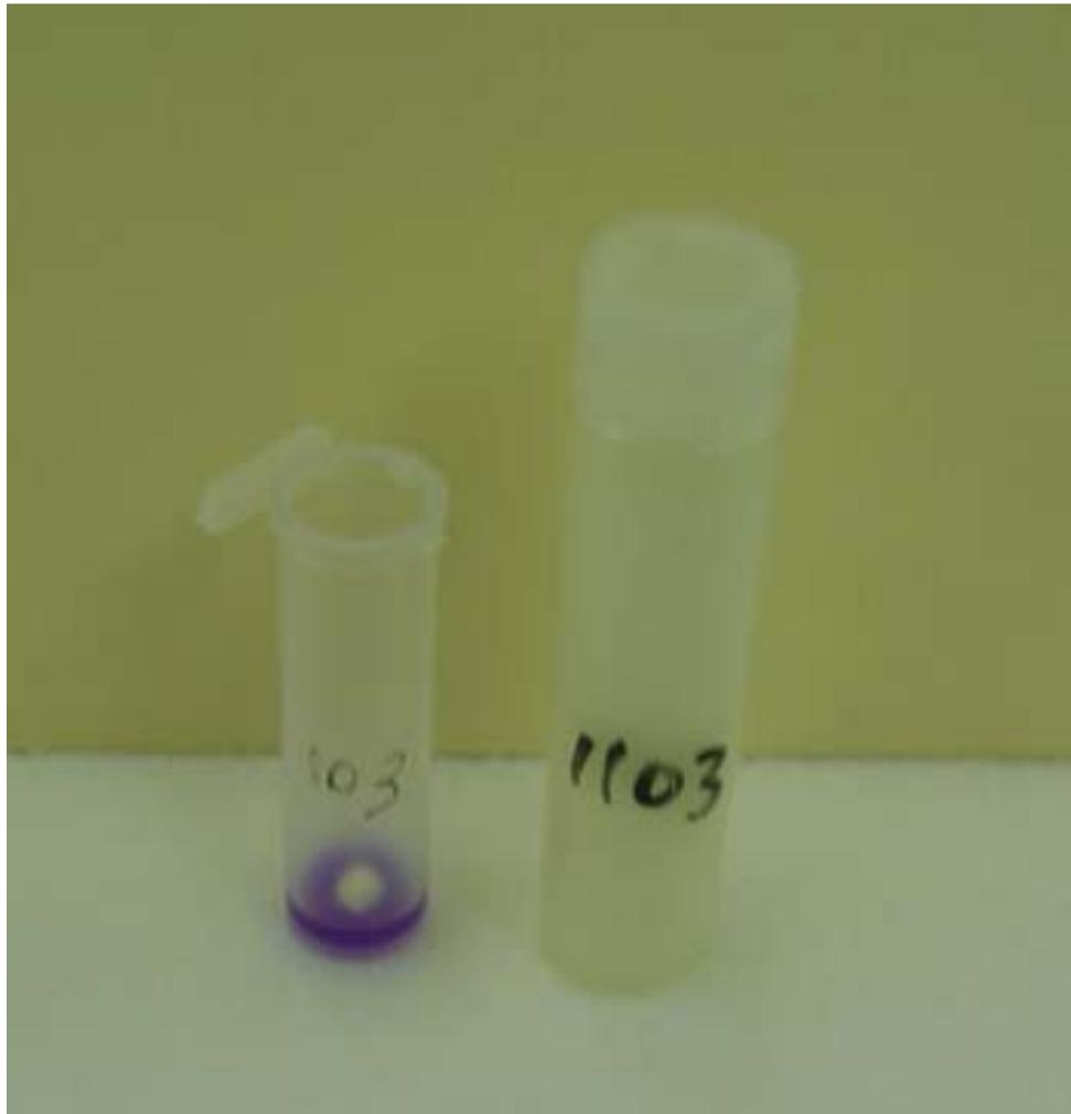
Figura 4 - Ampolas-teste contendo tablete de nutriente e identificada com número da amostra de leite a ser testada
