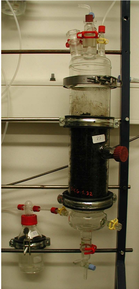
Figura 4.12 – Detalhe do biorreator.
