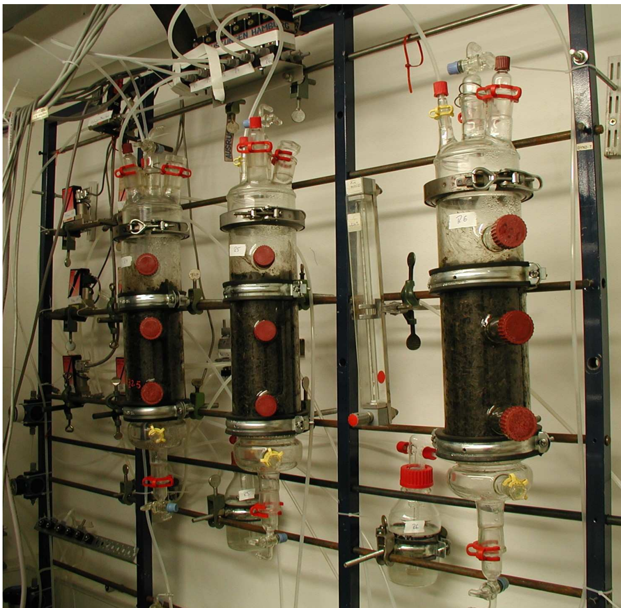
Figura 4.11 – Detalhe do conjunto de biorreatores.
