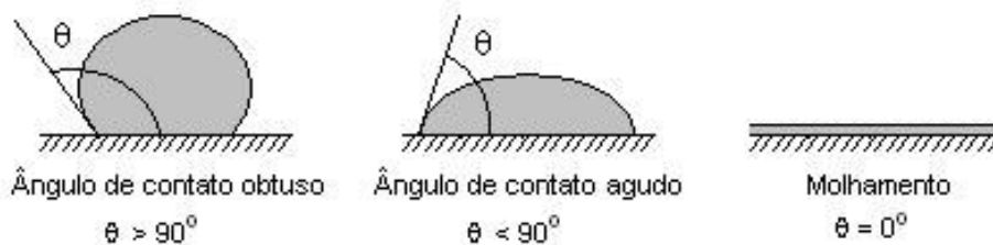
Figura 2.3 – Ângulo de contato \theta de uma gota de líquido contra uma superfície lisa
