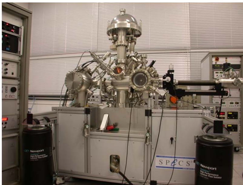
Figura 3.9: equipamento de XPS.
