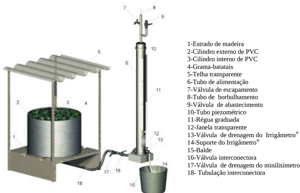
Figura 1 - Partes constituintes do minilísímetro com lençol freático constante e do Irrigâmetro ® modificado.
