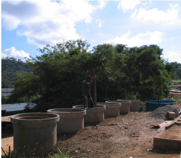
Figura 11 - Vista geral de estrutura experimental constituída pelo reservatório de produção de percolado (ao fundo) e as seis células enfileiradas.
