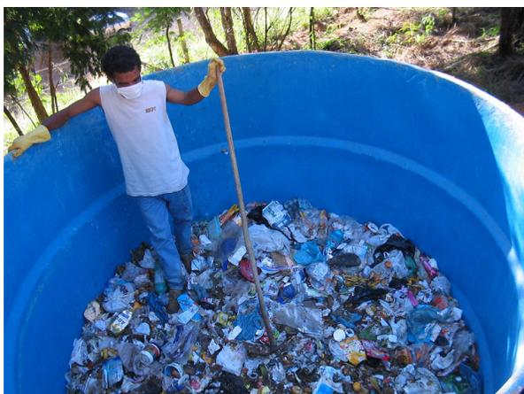
Figura 9 - Detalhe do preenchimento reservatório produtor de percolado.
