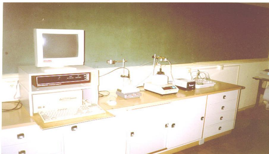
Figura 10 - Sistema de titulação potenciométrica automatizado.
