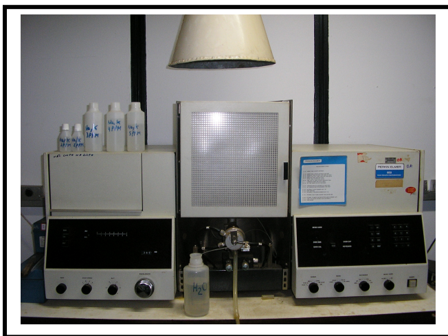
Fotografia 12 – Espectrômetro de Absorção Atômica Modelo PERKIN-ELMER 605
