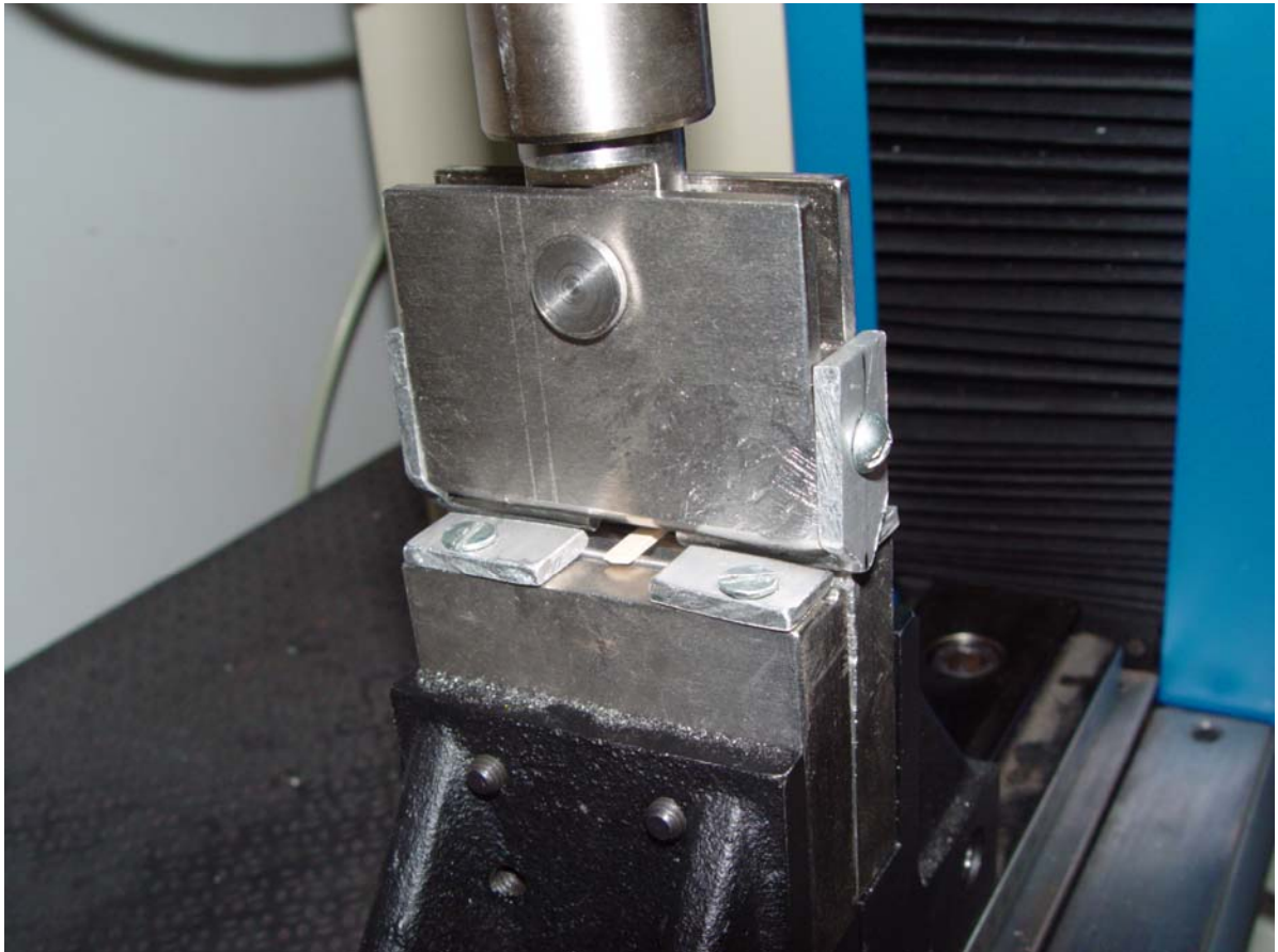
Figura 2. Dispositivo utilizado para o ensaio de carregamento de três pontos nas amostras de todos os grupos de teste.
