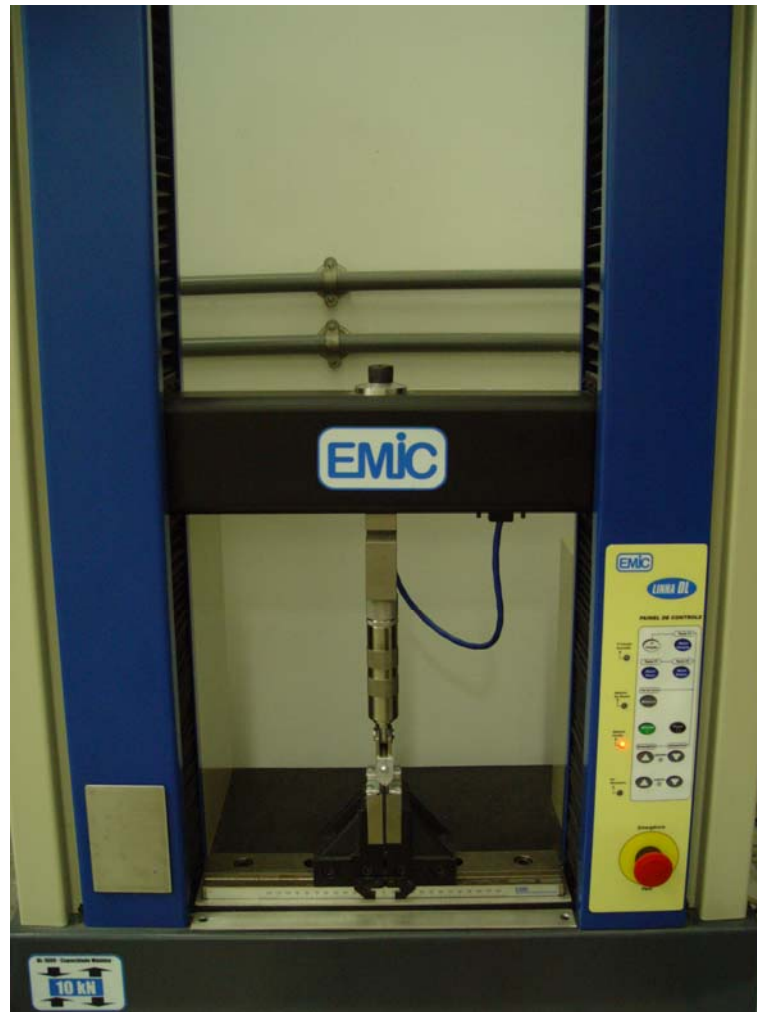
Figura 8. Máquina Emic onde o ensaio de carregamento flexural dos grupos de teste foi realizado.
