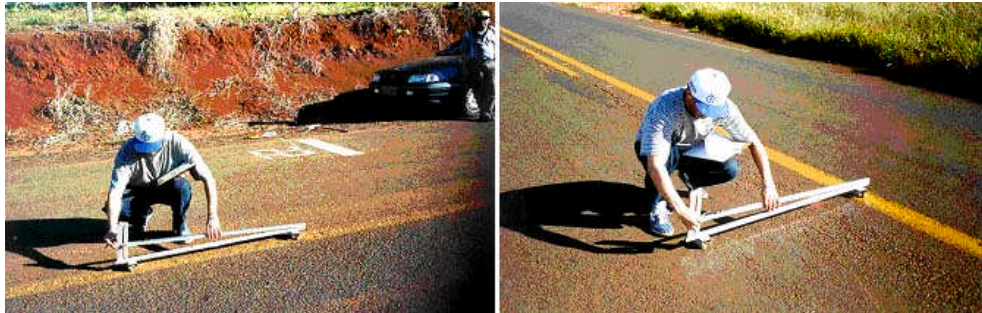
Figura 7 - Medidas de declividade com clinômetro desenvolvido na Escola de Engenharia de São Carlos (Fonte: VASCONCELOS, 2000)
