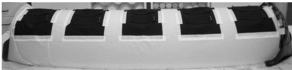
Figura 6. Cobertura utilizada durante os Testes de Evitamento – Gradiente de Contaminação. Sobre essa armação de tela plástica e papel branco, coloca-se uma cobertura de tecido preto. Em preto, são janelas para observação dos compartimentos (Donato et al., 2004).
