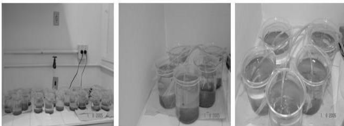
Figura 1. Desenho experimental para a realização do teste crônico com metais utilizando Chironomus xanthus .
