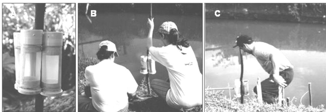
Figura 3. Seqüência da montagem do experimento “in situ”: (A) Câmaras de PVC (B) Colocação do sedimento da estação e (C) Colocação do experimento na estação selecionada.
