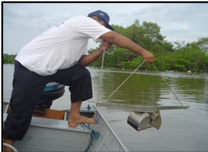
**Figura 09** - Draga *Van Veen* utilizada, em campo, na coleta de sedimentos.
