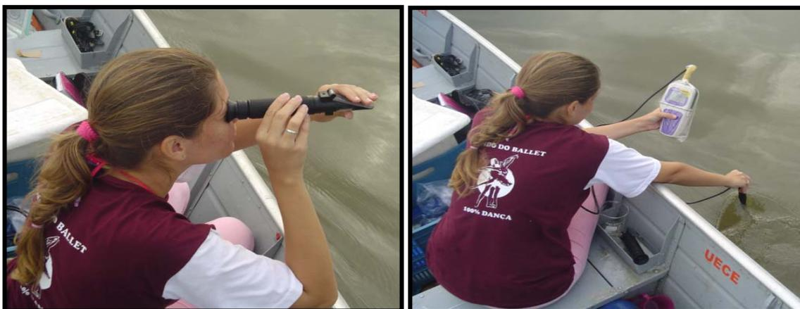
**Figura 06** – Na foto A, o refratômetro para medição da salinidade e na B, a sonda de Oxigênio, para medidas de O<sub>2</sub>, pH e temperatura.
