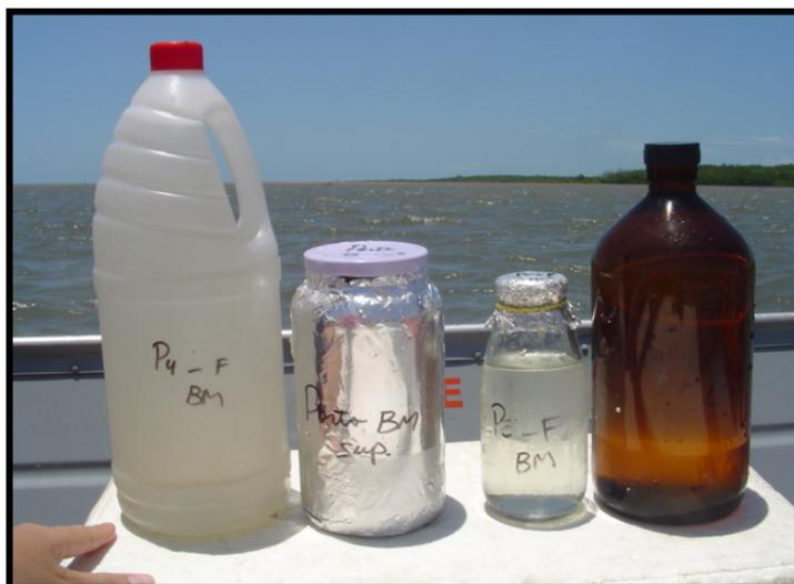
**Figura 11** – Frascos para as coletas de amostras de água: A) Clorofila A, Nitrogênio Total e DBO<sub>5</sub>, B) Óleos e graxas, C) Coliformes Termotolerantes e D) Fósforo.
