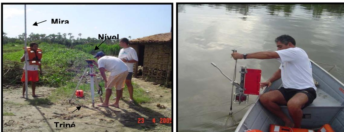
**Figura 05** – Na foto A, equipamento topográfico utilizado para a elaboração do perfil transversal no leito do Rio Acaraú, na seção 08 e na B, correntômetro, para medidas de corrente.
