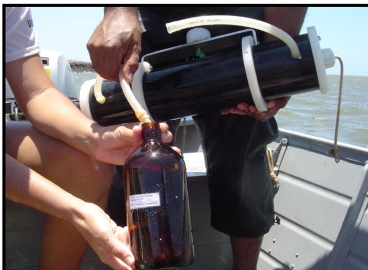
**Figura 08** - Garrafa *Van Dorn* utilizada nas coletas de água e material em suspensão.
