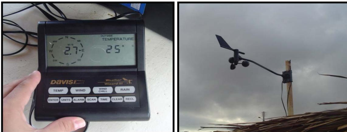
**Figura 10** – Na foto A, Estação Meteorológica Eletrônica Davis Instruments e na B, sensores de vento, direção e temperatura.
