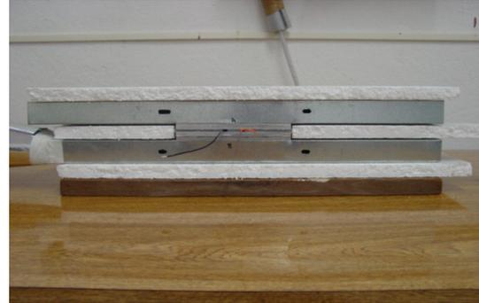
Figura 3.3 - Dissipadores de calor lado quente e lado frio, módulo termoeletrico e dutos - Sub-conjunto
