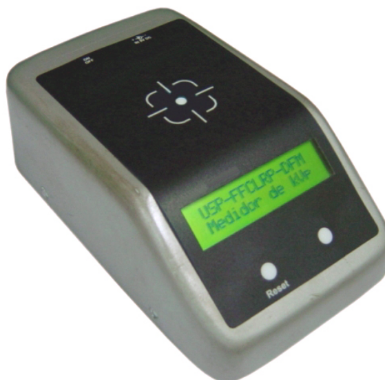
Figura 35 – Protótipo proposto para a determinação da kVp: (A) arranjo interno das placas eletrônicas; (B) protótipo montado
