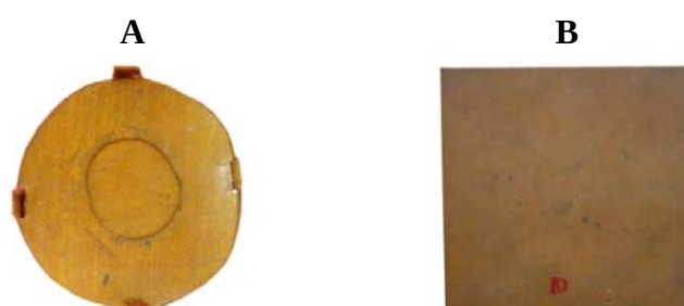
Figura 31 – Filtros utilizados no protótipo: (A) filtro interno fixado sobre os dois conjuntos de detectores; (B) filtro adicional posicionado na superfície externa da caixa do protótipo na região dos detectores para a determinação de quilovoltagem de pico entre 65 e 75 kVp
