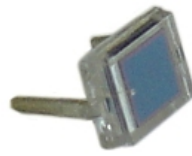
Figura 22 – Fotodiodo de silício utilizado na unidade de detecção de raios X
