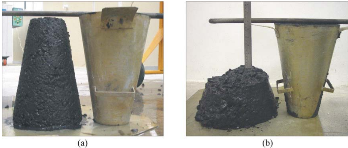
Figura 10.3 – Ensaio de abatimento do tronco de cone para o concreto com 20% de cinza ultrafina da casca de arroz antes (a) e após (b) correção da dosagem do aditivo superplastificante.
