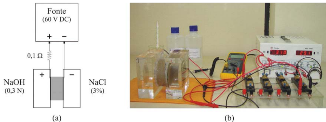
Figura 7.16 – Configuração do ensaio de penetração acelerada de íons cloreto (a) e ensaio em execução (b).
