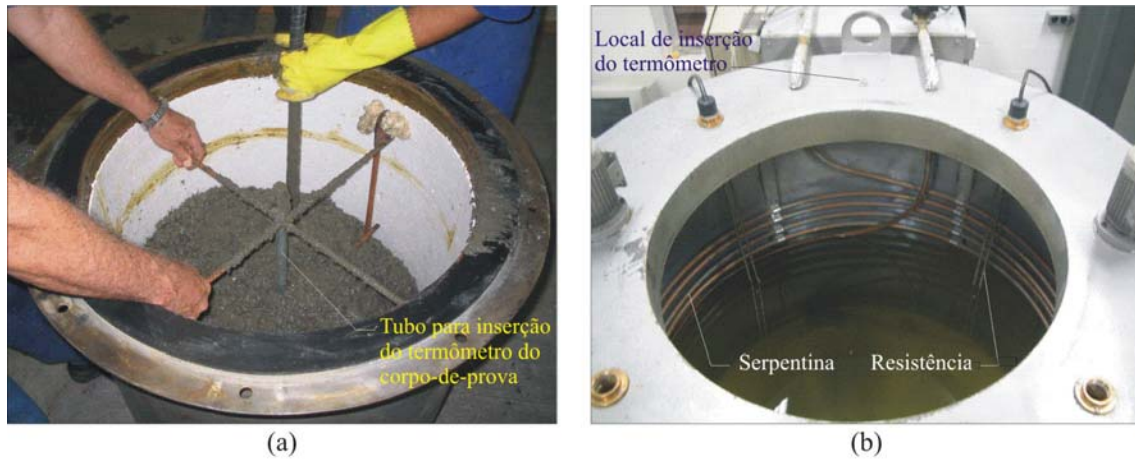
Figura 7.19 – Detalhes da moldagem do corpo-de-prova de concreto (a) e do interior do calorímetro (b).
