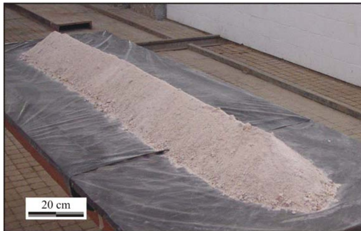
Figura 8.6 – Pilha cônica e alongada utilizada na homogeneização e no quarteamento da cinza residual do bagaço de cana-de-açúcar.
