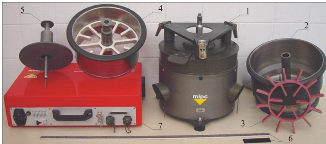
Figura 7.10 – Constituintes do reômetro BTRHEON: base que contém motores e transdutores (1), recipiente que comporta a amostra de concreto (2), grade fixa inferior (3), unidade de rotação com grade superior (4), dispositivo para medição da dilatância (5), fitas adesivas (6) e unidade eletrônica de controle (7).
