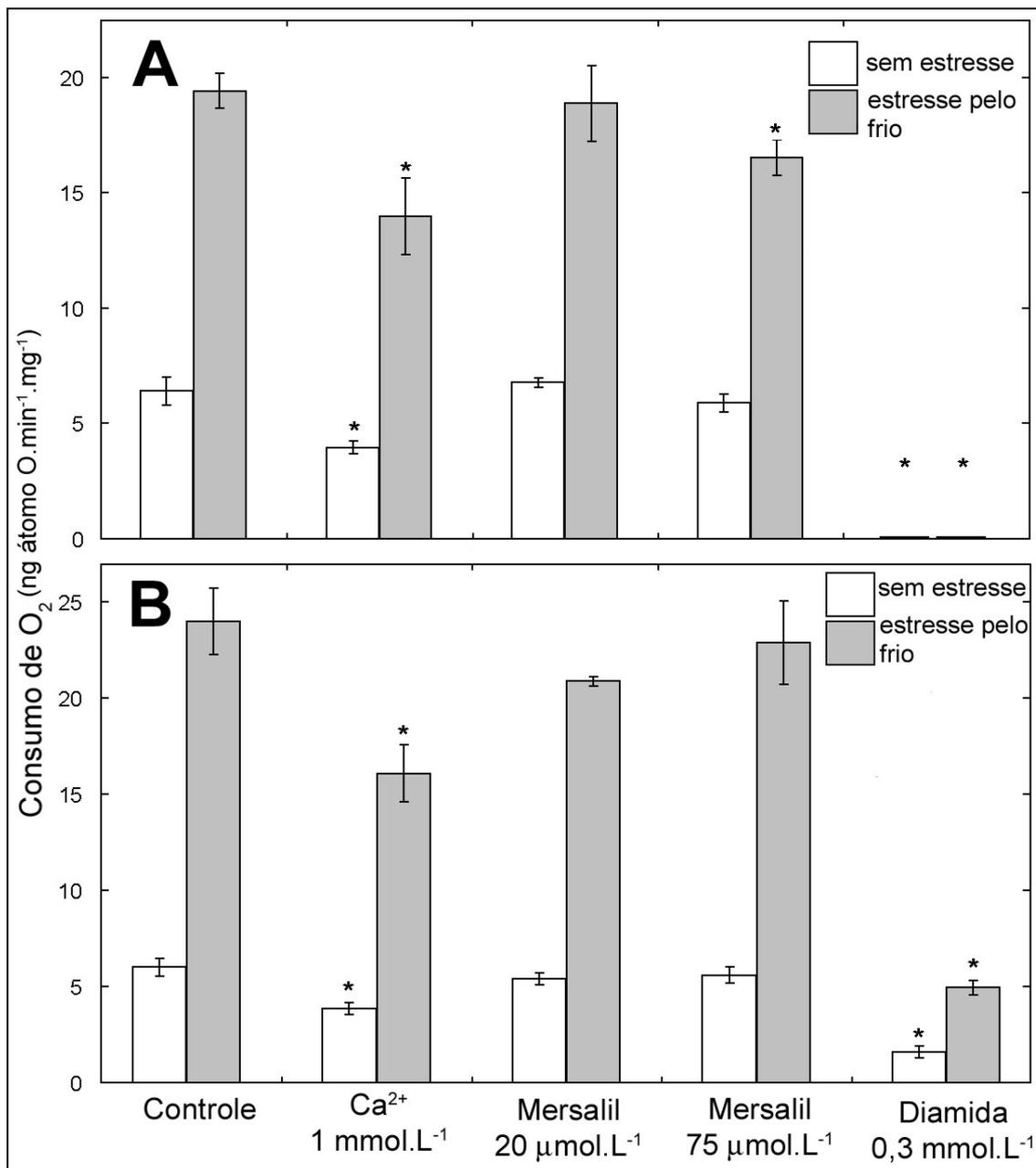
**Figura 7. Efeitos do Ca<sup>2+</sup>, mersalil e diamida sobre a oxidação de NADH externo e succinato em mitocôndrias isoladas de tubérculos de batata não estressados e estressados pelo frio**
