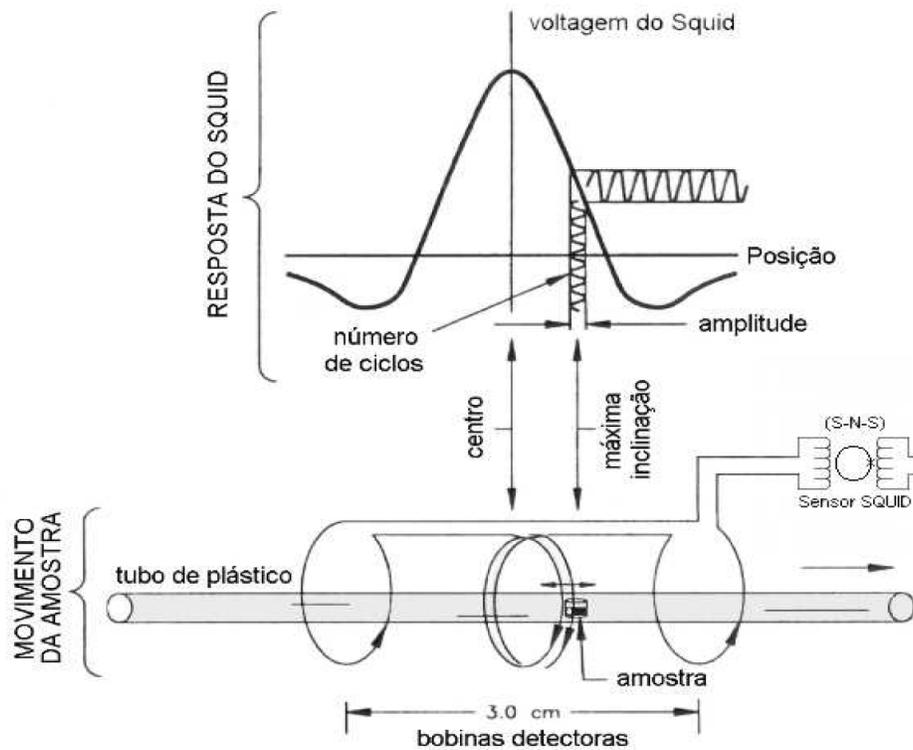
Figura 4.1: Esquema geral do sistema de detecção do magnetômetro SQUID onde a amostra está contida em um tubo plástico o qual se desloca entre as bobinas coletoras [51].
