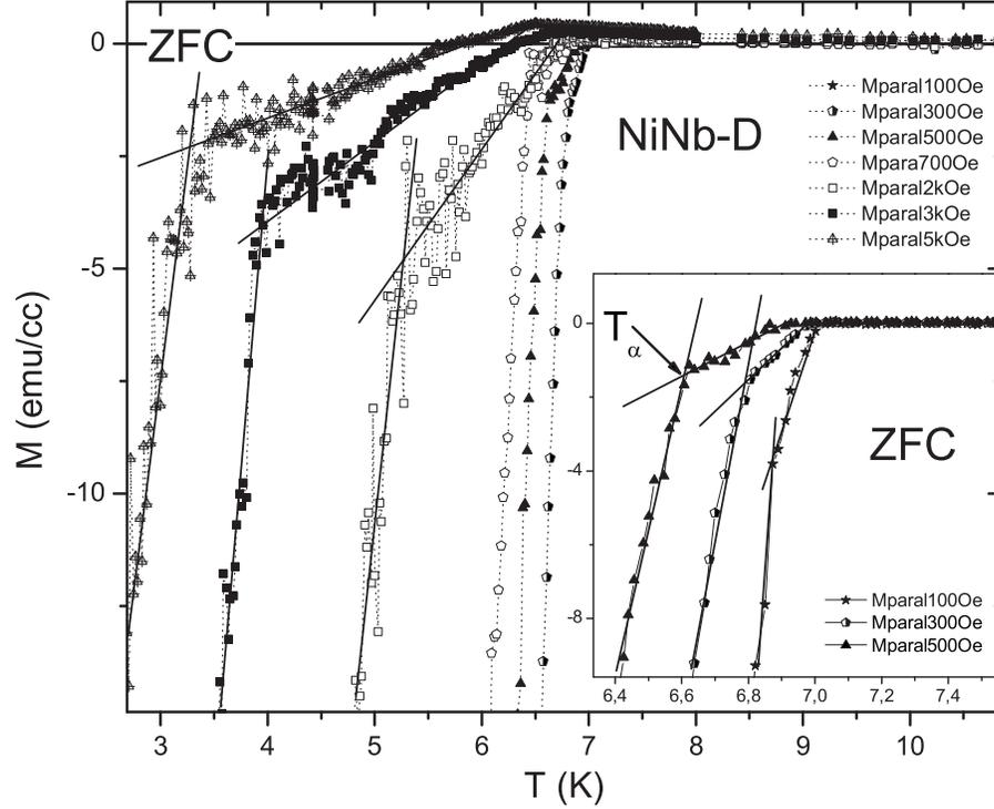
Figura 5.24: Curvas  $M \times T$  para a amostra NiNb-D onde fica mais notável a segunda transição. As retas auxiliares evidenciam o comportamento das curvas. Também é mostrado no detalhe uma visão ampliada das curvas de 100 a 500 Oe.
