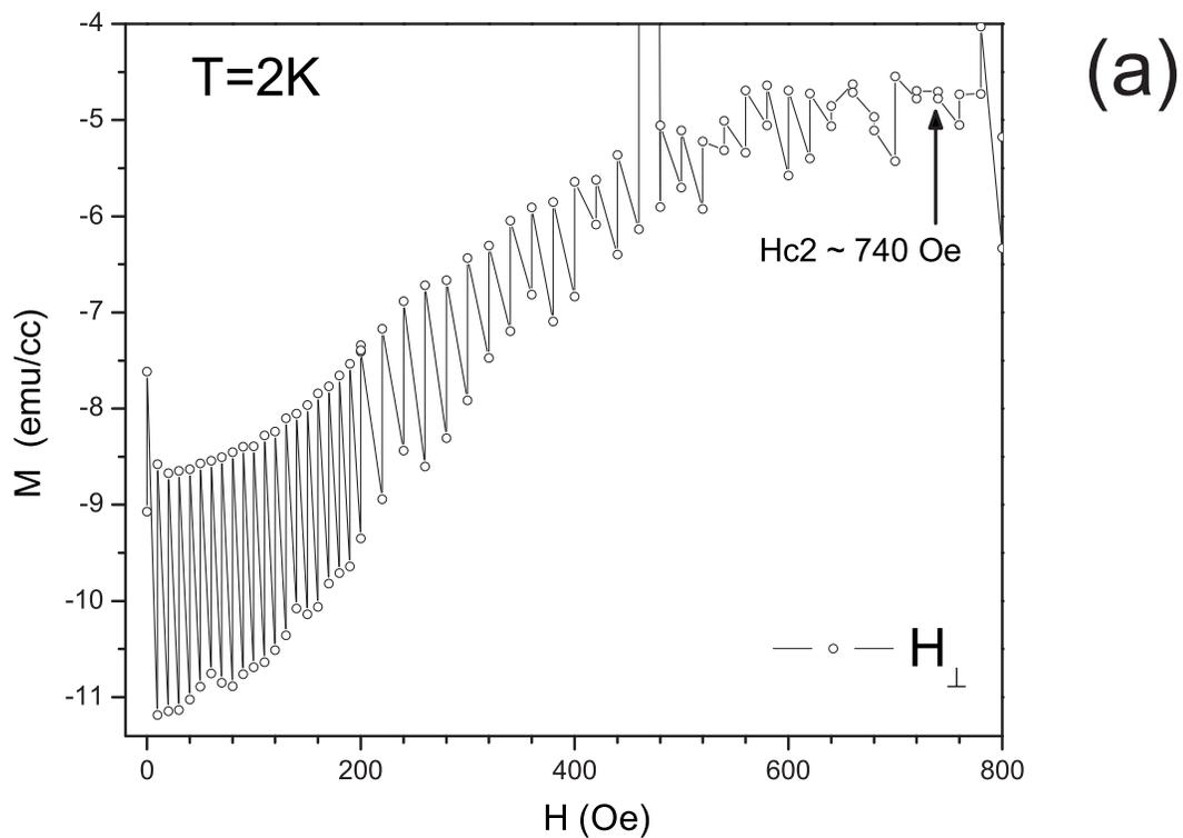
Figura 5.17: Curvas MxH para amostra NiNb-B . (a) É mostrado o trecho inicial da curva, para  $T = 2\text{ K}$ , onde se observa relaxações magnéticas do momento. Para cada valor de campo foram tomadas duas medidas.
