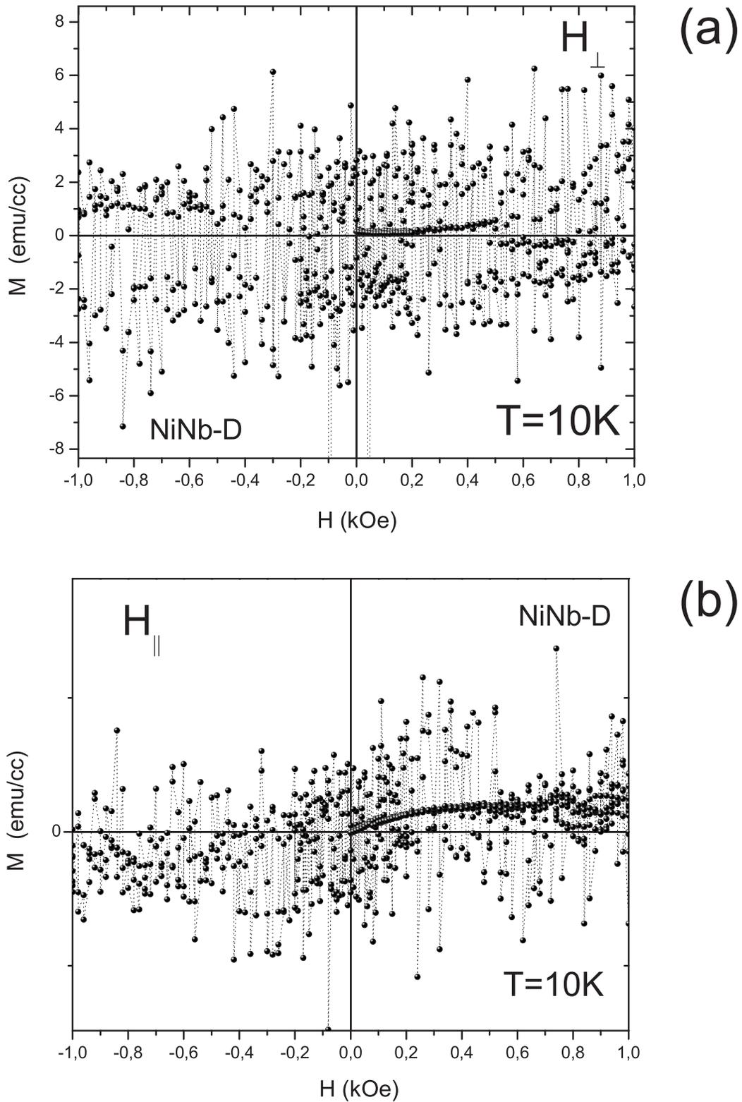
Figura 5.26: Curvas  $M \times H$  para  $T = 10$  K para a amostra NiNb-D, em ambas as orientações. É mostrada a região em torno de  $H = 0$ . (a) Curva para a orientação perpendicular. (b) Curva para a orientação paralela. O caráter reversível das curvas indica que a amostra possivelmente apresenta um caráter paramagnético.
