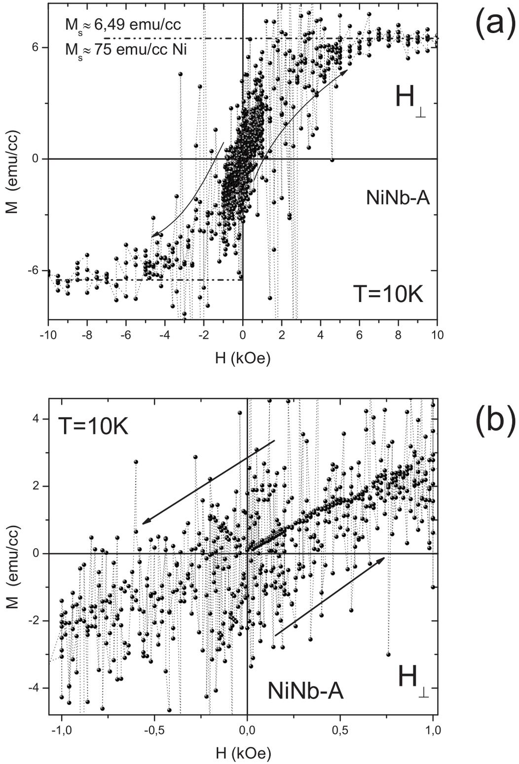
Figura 5.8: Curvas  $M \times H$  para a amostra NiNb-A na orientação perpendicular. (a) Para temperatura de  $T = 10 \text{ K}$ , onde a resposta é ferromagnética. (b) Ampliação da região em torno de  $\pm 1 \text{ kOe}$  onde fica clara a reversibilidade da curva. As setas indicam o sentido do aumento do campo aplicado.
