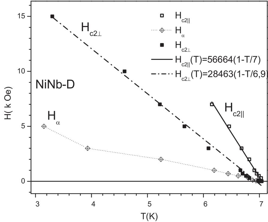
Figura 5.25: Diagrama HxT para a amostra NiNb-D para campos paralelo e perpendicular as camadas. O diagrama  $H_{\alpha}$  corresponde aos valores de temperatura onde ocorre a segunda transição, conforme mostrado na figura 5.24.
