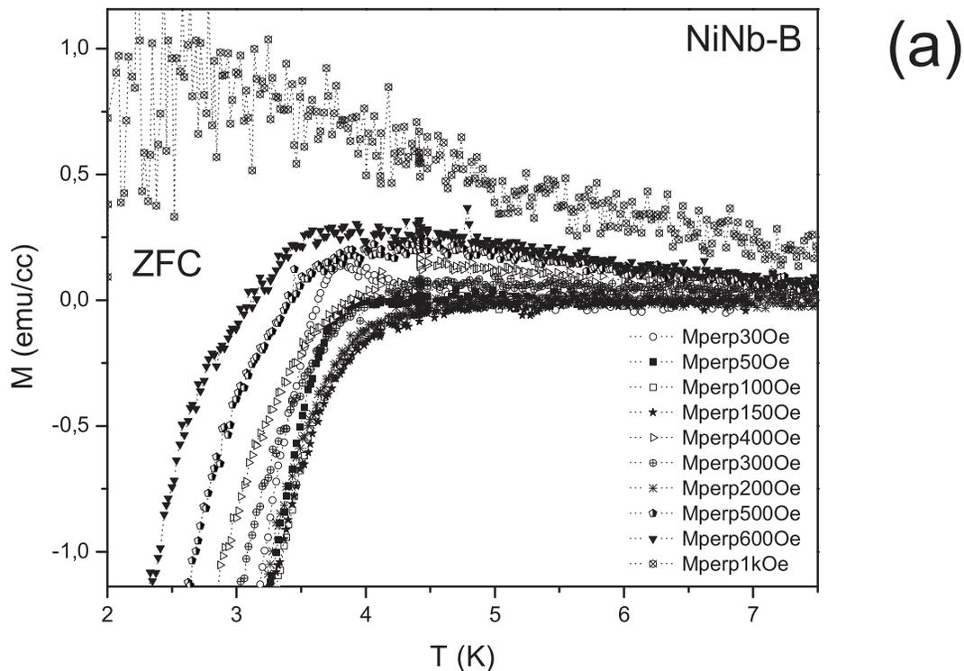
Figura 5.13: Curvas  $M \times T$  para a amostra NiNb-B. (a) Curvas ZFC para  $H_{\perp}$ , onde fica evidente a transição supercondutora. A curva para o campo de  $1 \text{ kOe}$  não apresenta transição para o estado superconductor.
