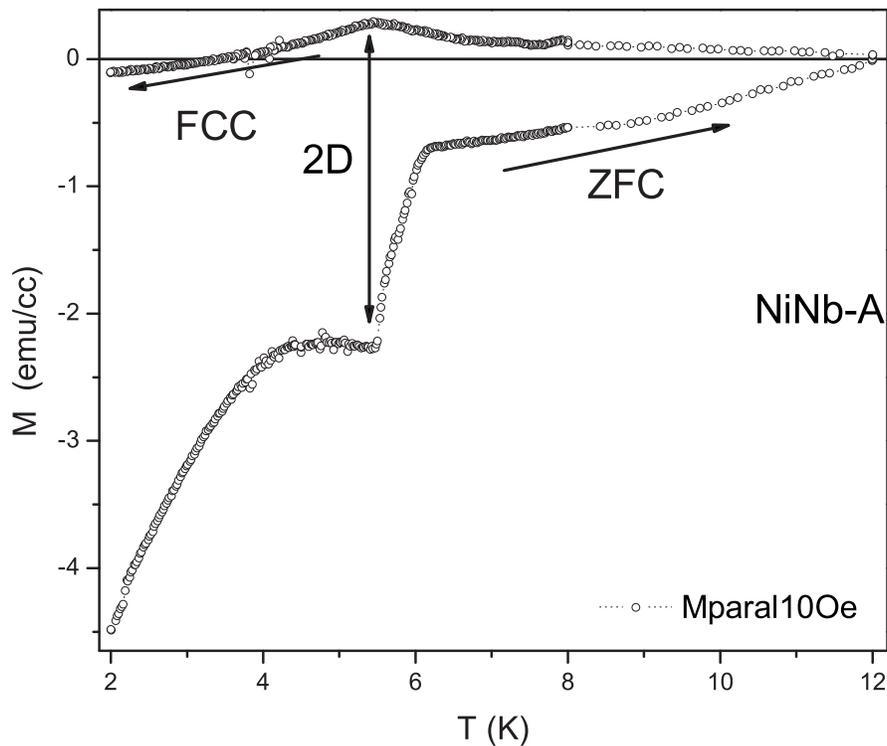
Figura 5.9: Curva  $M \times T$  para a amostra NiNb-A em um campo paralelo de 10 Oe onde é evidenciado uma segunda transição, possivelmente atribuída a uma mudança na dimensionalidade do acoplamento supercondutor conforme discutido no texto.
