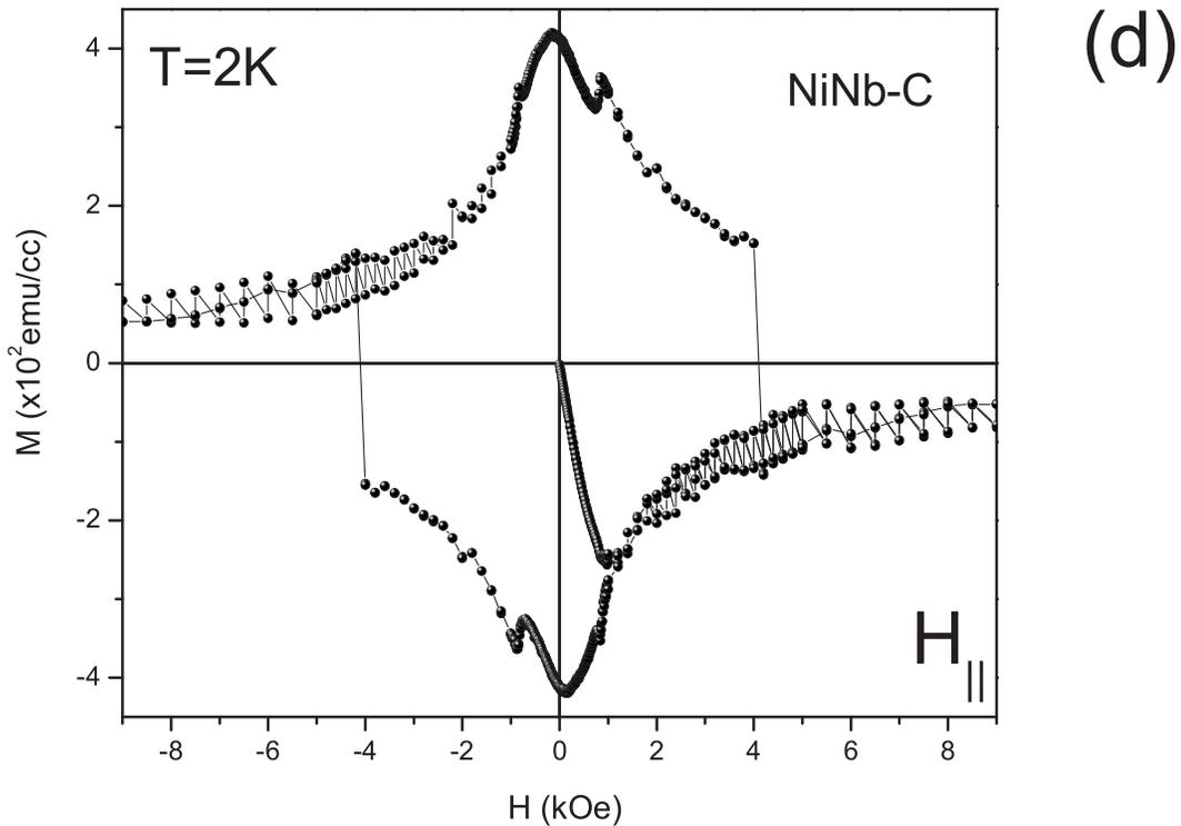
Figura 5.21: (*continuação*). (d) Curva  $M \times H$  para uma orientação paralela em  $T = 2$  K. Novamente o sinal é predominantemente supercondutor. Em ambas as orientações para  $T = 2$  K, as medidas não foram realizadas até campos suficientemente altos para levar a amostra para o estado normal.
