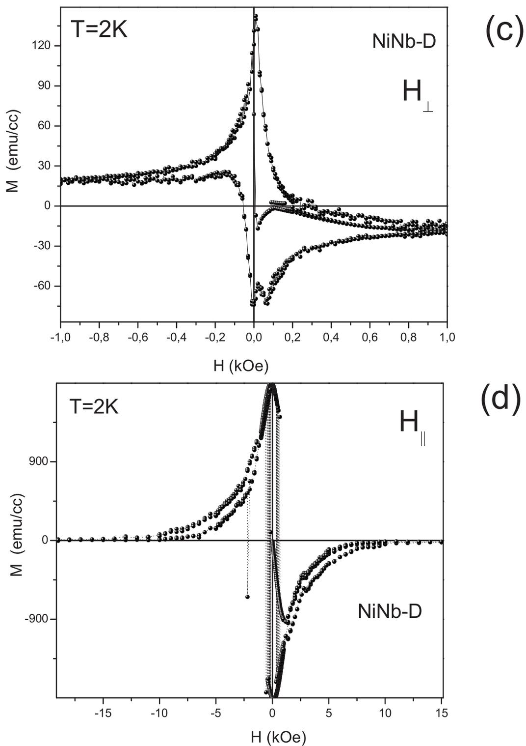
Figura 5.26: (continuação). Curvas  $M \times H$  para  $T = 2 \text{ K}$  para a amostra NiNb-D, em ambas as orientações. (c) Curva para a orientação perpendicular. (d) Curva para orientação paralela. Nas duas curvas o intervalo de campo aplicado não foi suficiente para levar a amostra ao estado normal.
