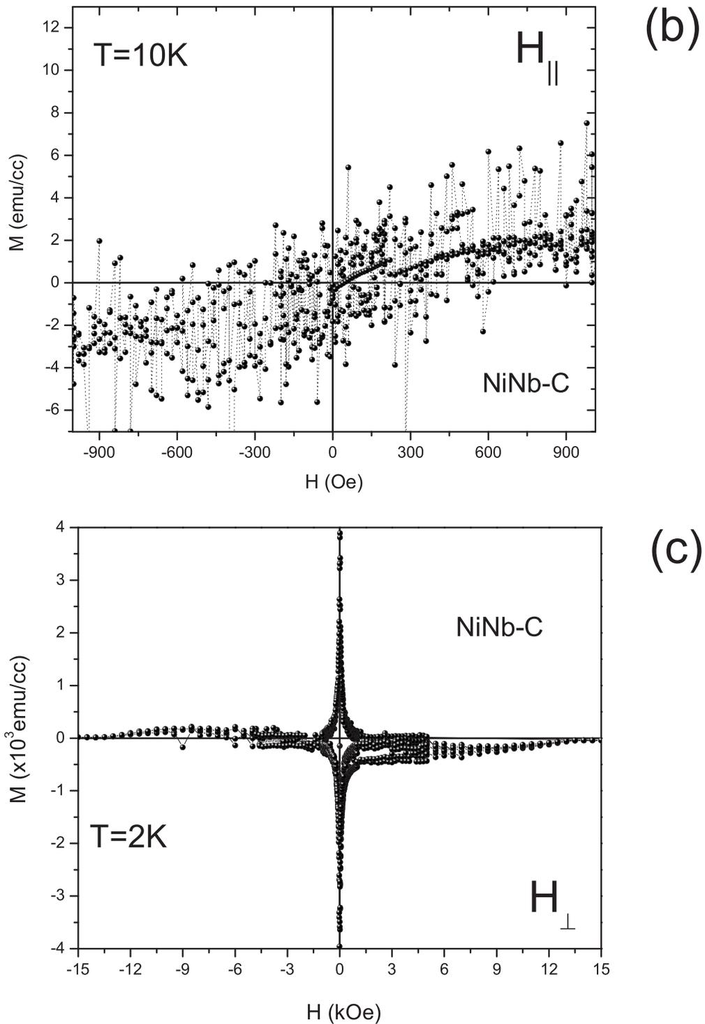
Figura 5.21: (continuação). (b) Campo aplicado paralelamente as camadas para  $T = 10$  K. Como no caso perpendicular, aqui a curva é reversível indicando um possível comportamento paramagnético. (c) Campo aplicado perpendicularmente para  $T = 2$  K. onde o sinal é predominantemente supercondutor.
