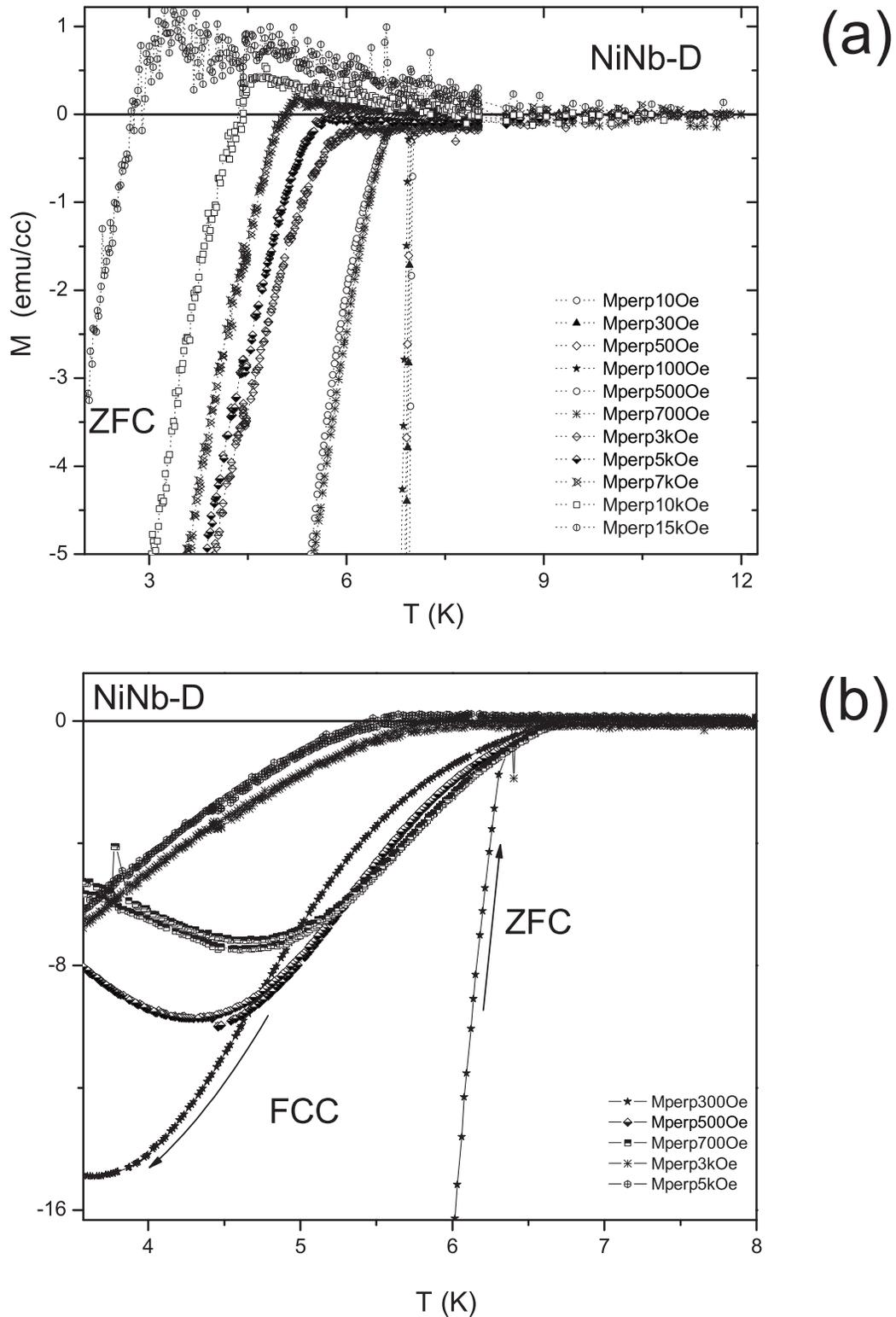
Figura 5.22: Curvas  $M \times T$  para a amostra NiNb-D na orientação perpendicular. (a) As curvas para  $H_{\perp}$  mostram uma transição abrupta. (b) No processo FCC é mostrada a tendência da magnetização em assumir uma variação semelhante a uma parábola como observado no caso das amostras NiNb-A e NiNb-C.
