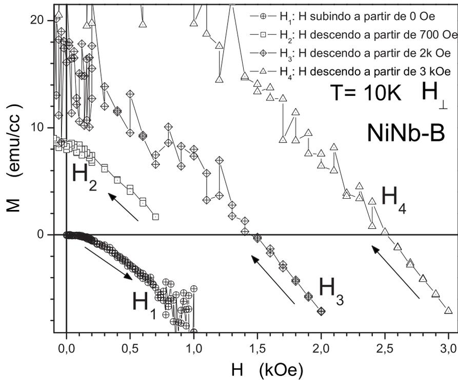
Figura 5.17: (continuação). (b) Conjunto de curvas  $M \times H$  para diferentes condições iniciais mostrando o caráter sistemático das instabilidades do momento magnético. Após uma variação de 700 Oe são observadas as instabilidades para todas as curvas.
