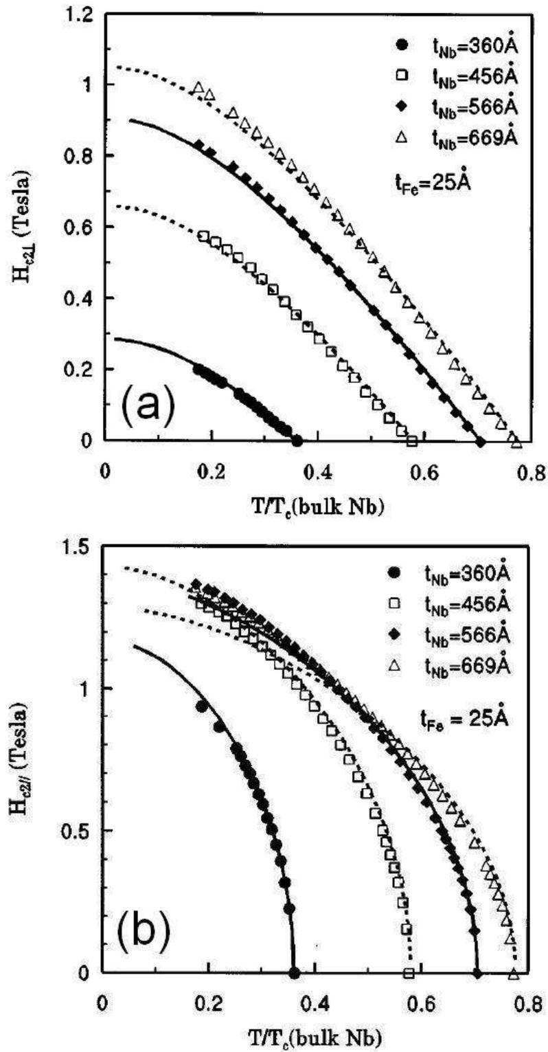
Figura 3.4: Campos críticos paralelo e perpendicular às camadas de Nb. As linhas sólidas correspondem ao cálculo realizado com as equações 3.3 e 3.4, usando  $\epsilon = 3,36$  e  $\xi_S = 77,8 \text{ \AA}$  [9].
