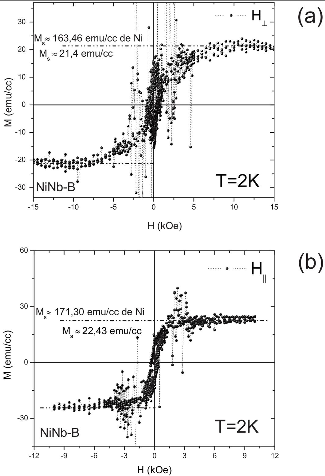
Figura 5.16: Curva  $M \times H$  para a amostra NiNb-B na orientação perpendicular (figura a) e paralela (figura b) ao campo. É verificado um comportamento ferromagnético mesmo abaixo da temperatura de transição supercondutora.
