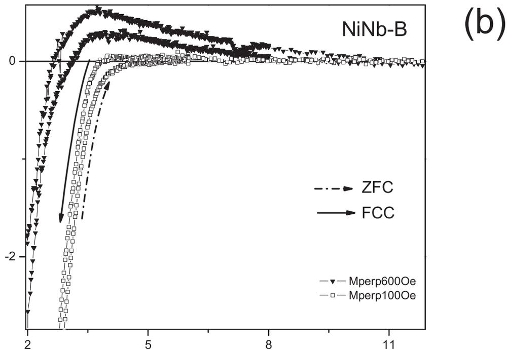
Figura 5.13: (*continuação*). Curvas  $M \times T$  para a amostra NiNb-B. (b) Curvas para campos de 100 Oe e 600 Oe, em ambos os regimes, ZFC-FCC. Na curva de 600 Oe fica clara a irreversibilidade desde 12K, mostrando a forte influência magnética das camadas de Ni.
