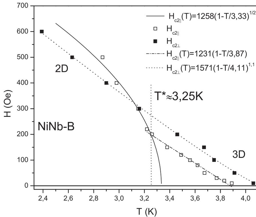
Figura 5.15: Diagrama  $H \times T$  para a amostra NiNb-B. No caso paralelo é claro uma transição dimensional em 3,25 K. O comportamento bidimensional é bem ajustado pela curva parabólica conforme mostrado. No caso perpendicular o comportamento é aproximadamente linear com uma pequena curvatura positiva, o que é verificado pelo ajuste com expoente 1,1.
