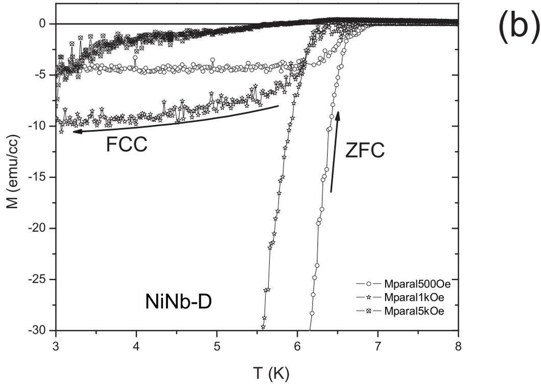
Figura 5.23: (*continuação*). Curvas  $M \times T$  para a amostra NiNb-D na orientação paralela. (b) Curva para o caso paralelo, onde são mostradas algumas curvas e observa-se que nesta orientação não ocorre a tendência observada no processo FCC do caso perpendicular.
