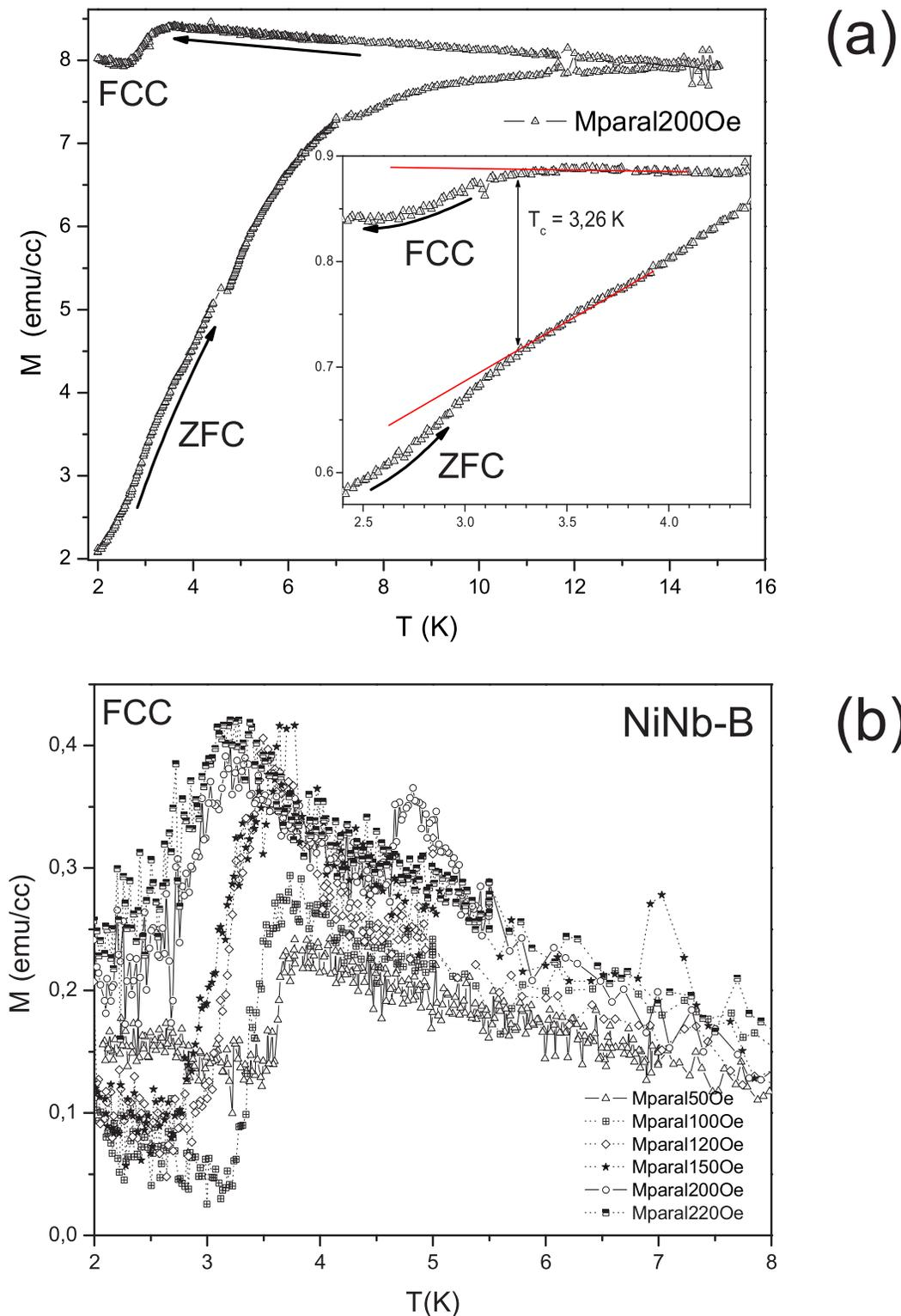
Figura 5.14: Curvas  $M \times T$  para a amostra NiNb-B na orientação paralela. (a) Curvas ZFC-FCC para um campo de 200 Oe a transição para o estado supercondutor fica mais clara no regime FCC. No detalhe é mostrada a correspondência da transição supercondutora em ambos os regimes. (b) Algumas curvas no regime FCC, que foram usadas para determinar a linha  $H_{c2}(T)$ .
