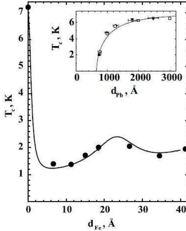
Figura 3.2: Dependência de  $T_c$  com a espessura da camada de Fe,  $d_{Fe}$ , para um valor da camada de chumbo  $d_{Pb} = 730$  Å. [47]. A linha cheia representa um ajuste com a teoria de Tagirov [46]. No detalhe é apresentada a redução monotônica de  $T_c$  com a redução da espessura da camada de chumbo, para uma espessura fixa de Fe, igual a 30 Å.
