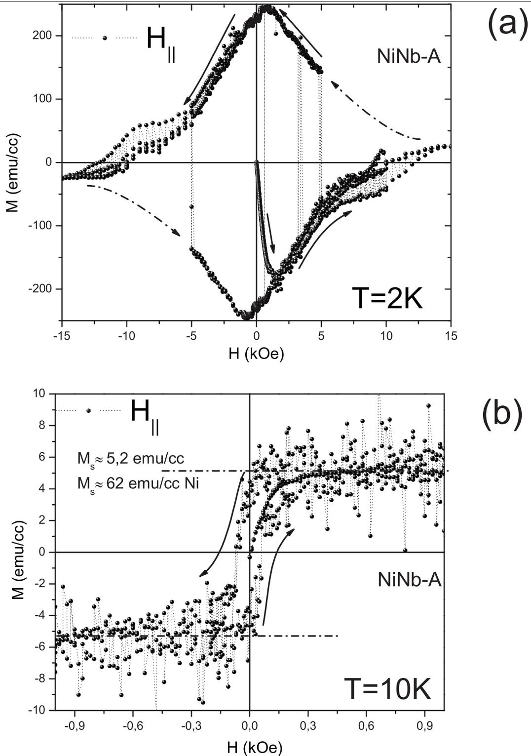
Figura 5.12: Curvas  $M \times H$  para a amostra NiNb-A na orientação paralela. As setas em linha sólida indicam o sentido da variação do campo. (a) Para temperatura de  $T = 2$  K, onde o sinal supercondutor predomina. As setas traço-pontilhadas indicam como seria a forma da curva na ausência de saltos. (b) Para  $T = 10$  K (acima de  $T_d$ ), onde o sinal ferromagnético é observado.
