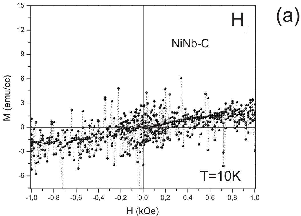
Figura 5.21: Curvas  $M \times H$  para a amostra NiNb-C . (a) Campo aplicado perpendicularmente as camadas para  $T = 10$  K. A reversibilidade da curva indica que possivelmente a amostra NiNb-C apresenta um comportamento paramagnético.
