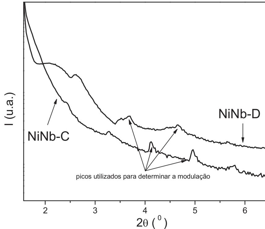
Figura 5.1: Padrão de difração de raios X em baixo ângulo para as amostras NiNb-D e NiNb-C. As curvas apresentam uma periodicidade típica de sistemas multicamadas no intervalo  $4^\circ < 2\theta < 5^\circ$ .
