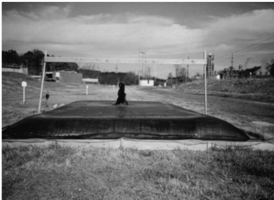
Figura 3.4: Tubo após 26 dias de consolidação (Fowler et al 2002)
