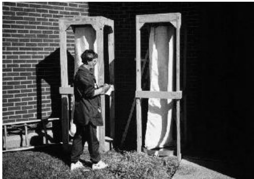
Figura 3.2: Esquema de montagem do “bag test” para duas amostras (Fowler et al 2002).
