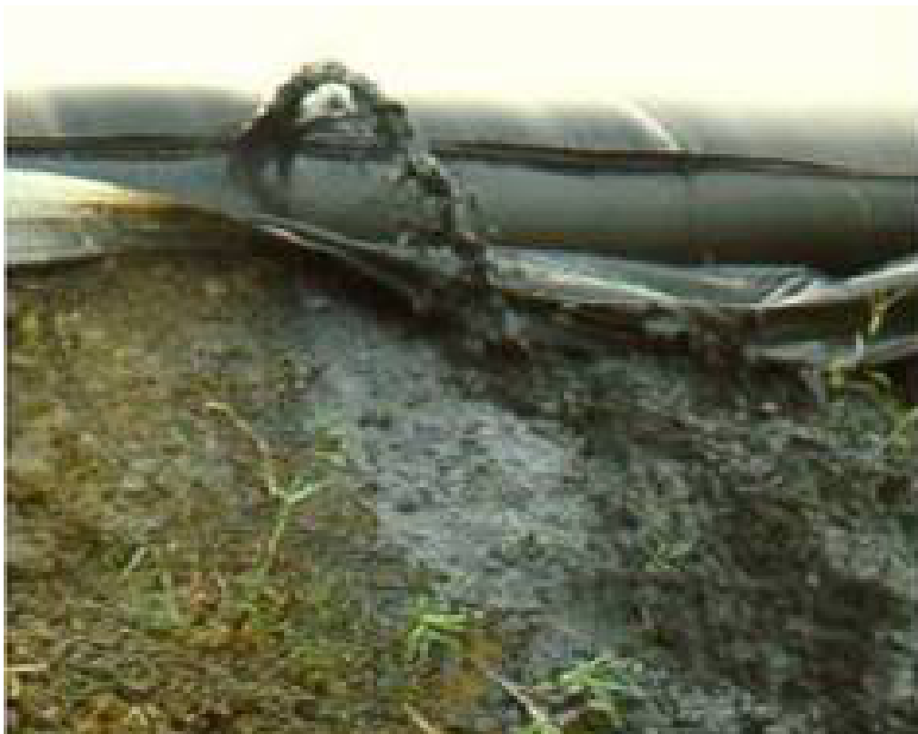
Figura 5.9: Exemplo de falhas na costura de um tubo de Geotêxtil em Mobile-Alabama /EUA (Leshchinsky e Leshchinsky 2002).
