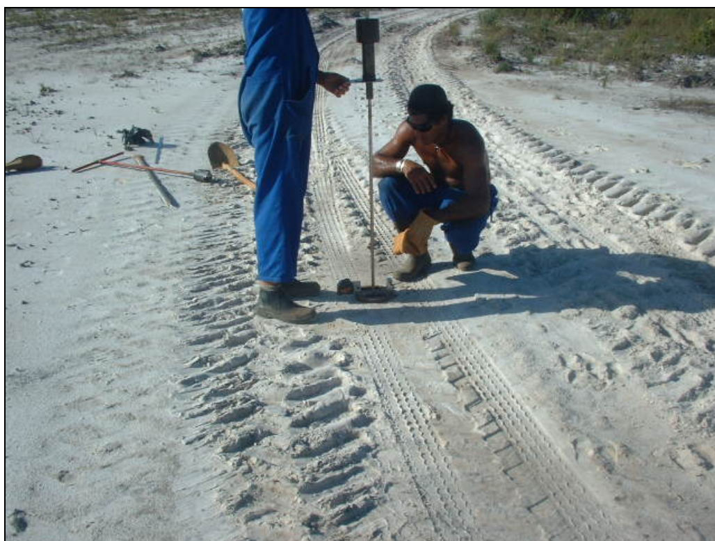
Figura 26: Cravação do DCP – Sob a trilha de roda
