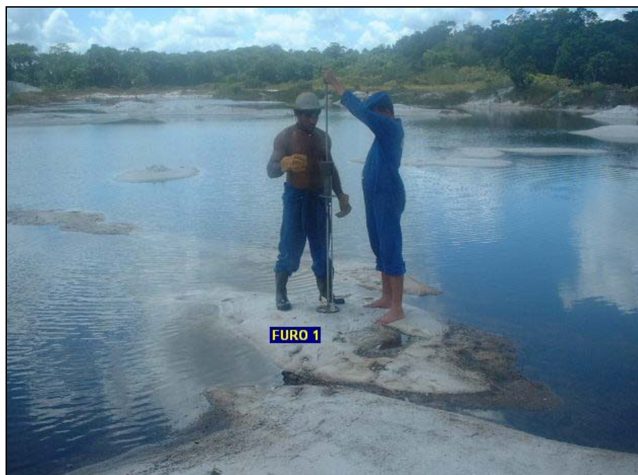
Figura 24: Cravação do DCP – Jazida submersa (Furo 1)
