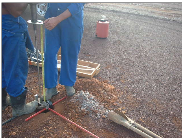
Figura 20: Cravação do DCP – Areia desconfinada parcialmente
