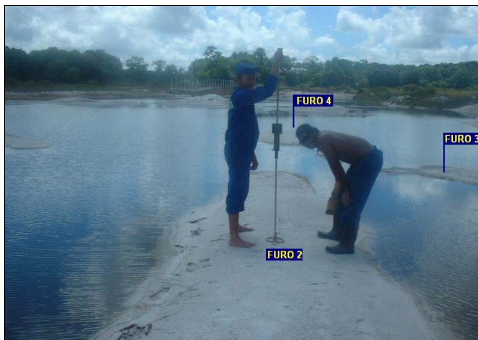
Figura 25: Cravação do DCP – Jazida submersa (Furos 2,3 e 4)
