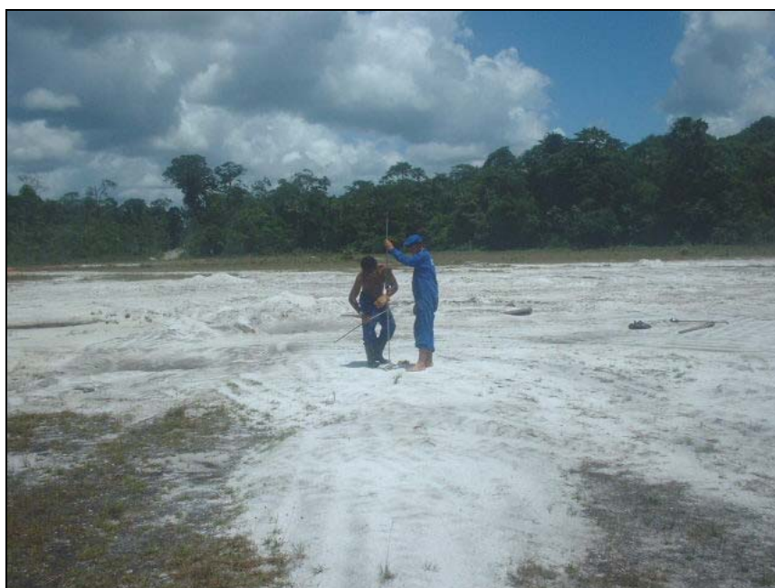
Figura 22: Cravação do DCP – Jazida, superfície seca
