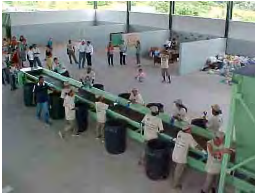
Foto: Marcelino Andrade Gonçalves Foto 25 - Esteira instalada na Cooperlix para realização da triagem dos resíduos sólidos recicláveis, 2004
