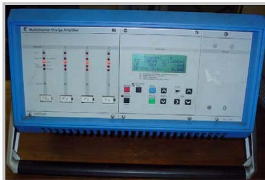
Figura 3.11 – Amplificador de carga multicanal *Kistler* modelo 5019
