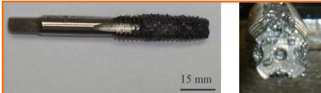
Figura 4.54 - Fotos ilustrativas de um macho de corte após usinar ferro fundido cinzento com óleo lubrificante (MQL)
