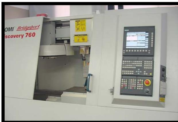
Figura 3.1 – Centro de usinagem vertical, modelo Discovery 760 (ROMI)
