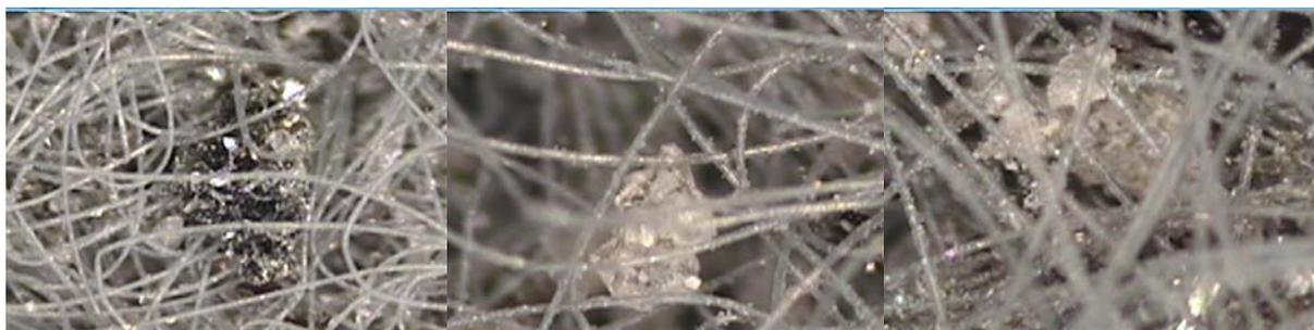
**Figura 5.32. Imagens da superfície de interface do geotêxtil com o solo após ensaio.**
