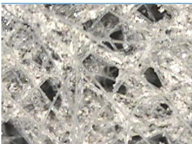
**Figura 5.29.** Imagem parte inferior do geotêxtil G1 após ensaio E2.
