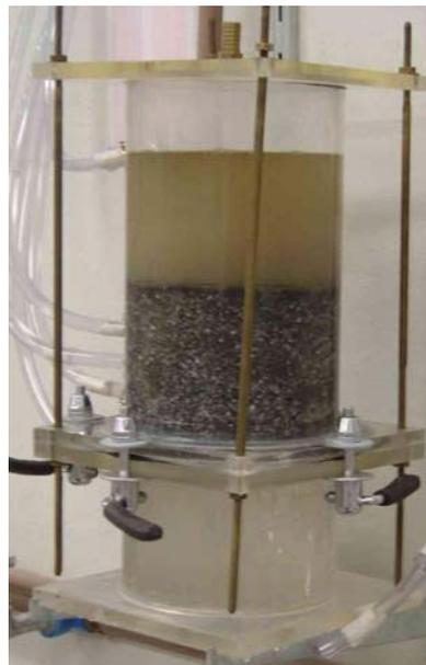
**Figura 4.7. Ensaio realizado com fluxo ascendente com elevação do particulado fino.**
