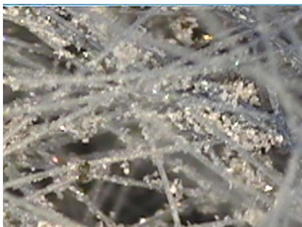
**Figura 5.31.** Imagem parte inferior do geotêxtil G2 após ensaio E6.
