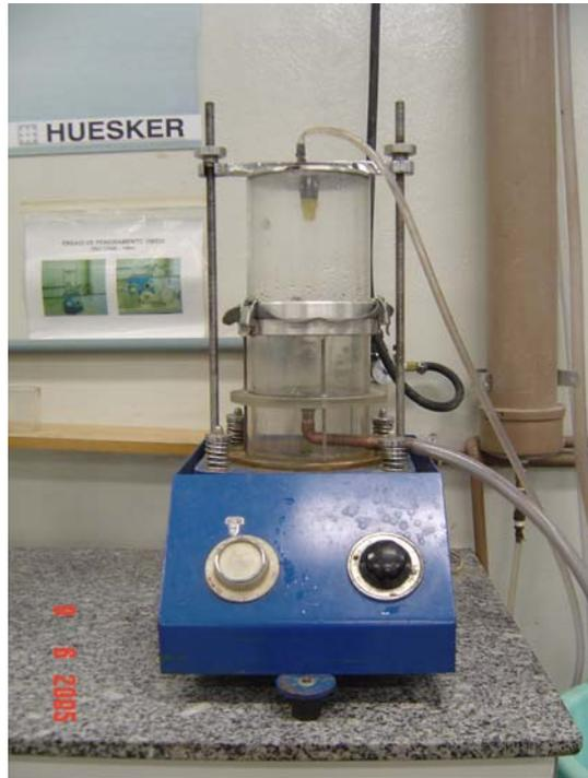
**Figura 4.3. Equipamento para ensaio de abertura de filtração por peneiramento via úmida.**
