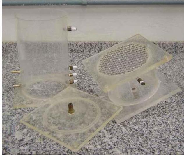
**Figura 4.6. Detalhes do permeâmetro.**
