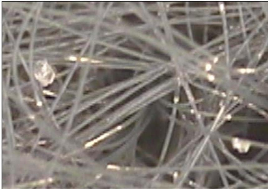
Figura 5.3. Furo de agulhagem geotêxtil G1 e partícula entre peneiras 140 e 170.
