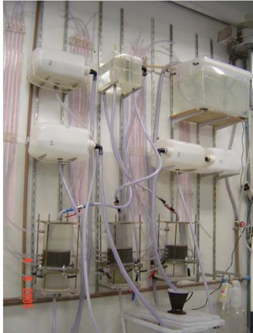
**Figura 4.5. Equipamento de ensaio de razão entre gradientes.**
