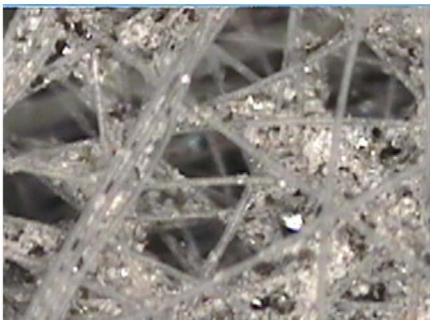
**Figura 5.27.** Imagem parte inferior do geotêxtil G1 após ensaio E1.
