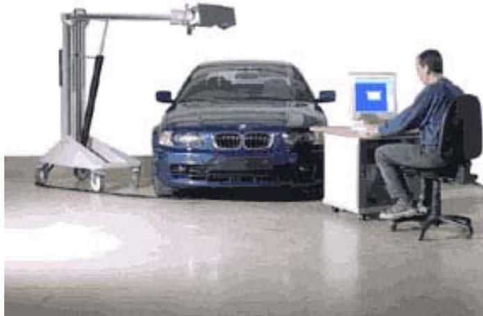
Figura 2.1.1 – Scanner 3d sendo usado para criar o modelo digital do automóvel.
