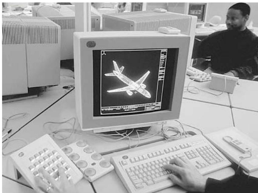
Figura 2.2.2 – Exemplo de modelo tridimensional em *wireframe*.
