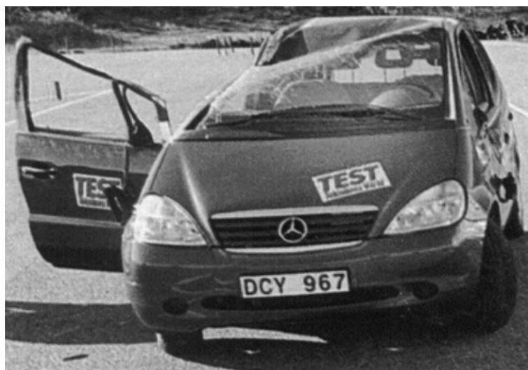
Figura 2.1.2 – Mercedes Classe A após o teste do alce.
