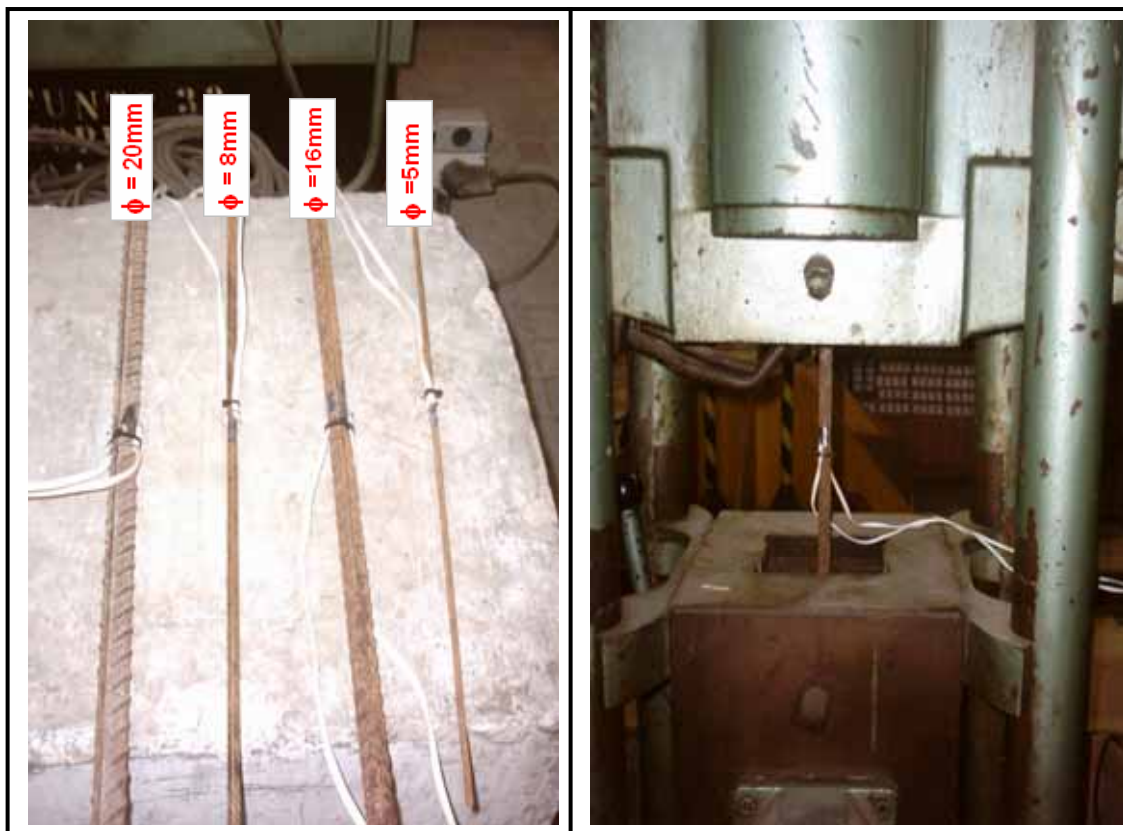
Figura 3.1 – Barras de aço instrumentadas e prensa usada no ensaio de tração simples das barras.
