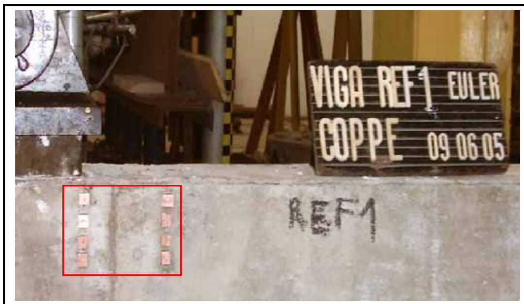
Figura 3.20 – Detalhe das chapas de cobre coladas nas vigas para medição com extensômetro mecânico.
