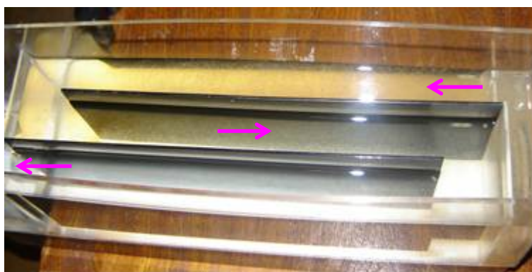
Figura 5.24 – Vista superior do decantador. As setas indicam o sentido do escoamento.
