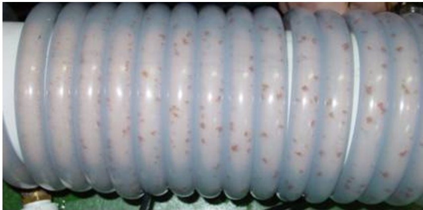
Figura 3.10 – Formação de flocos no Floclador Tubular Helicoidal Fonte: Carissimi, 2003.
