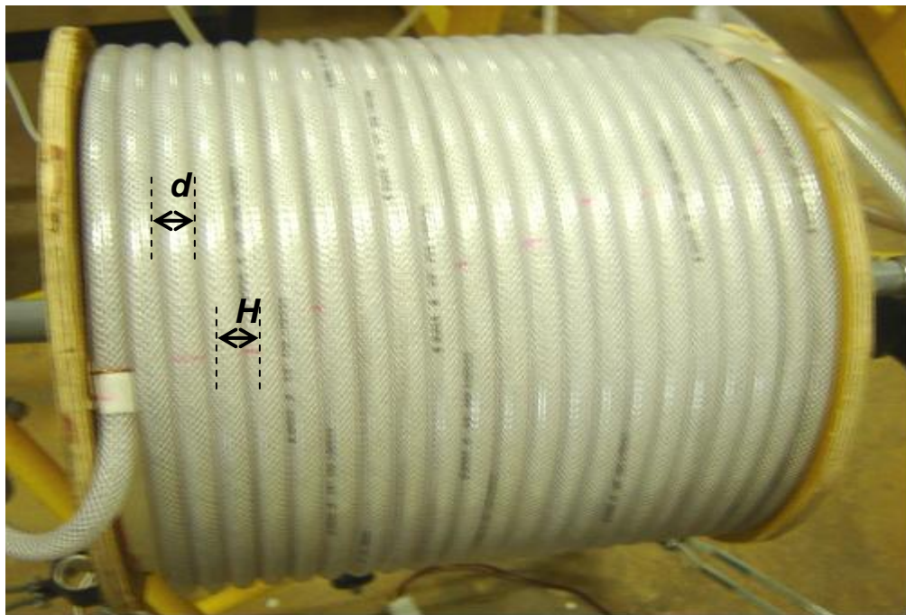
Figura 4.5 – Vista superior do Floculador Tubular Helicoidal (FTH). Onde d é o diâmetro da mangueira e H é o espaçamento entre voltas.
