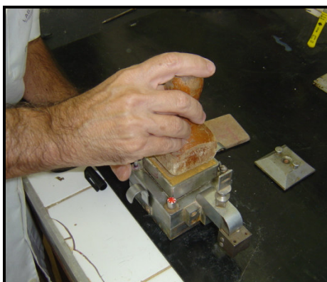
Figura 5.6 – Transferência do solo para a caixa bi-partida.
