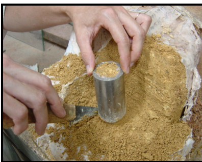
Figura 5.15 – Retirada de amostra indeformada para a realização do ensaio de permeabilidade.
