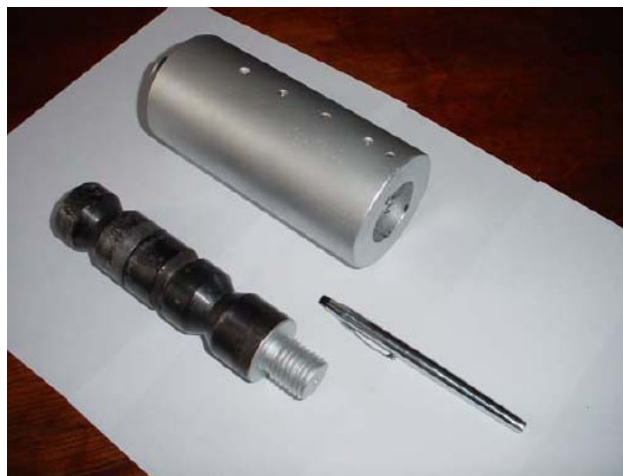
Figura 5.11: Vista dos cilindros externo e interno do dissipador de chumbo (Curadelli, 2003)
