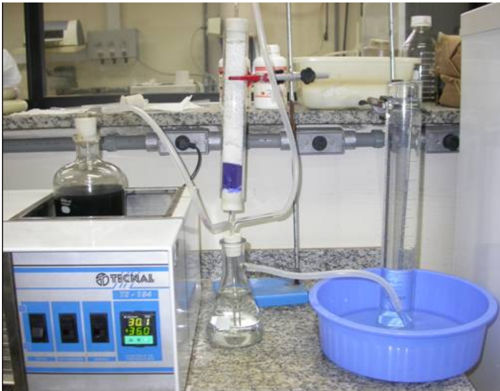
Figura C.1 - Foto do teste montado no LabPol – COPPE para atividade metanogênica do lodo anaeróbico do UASB
