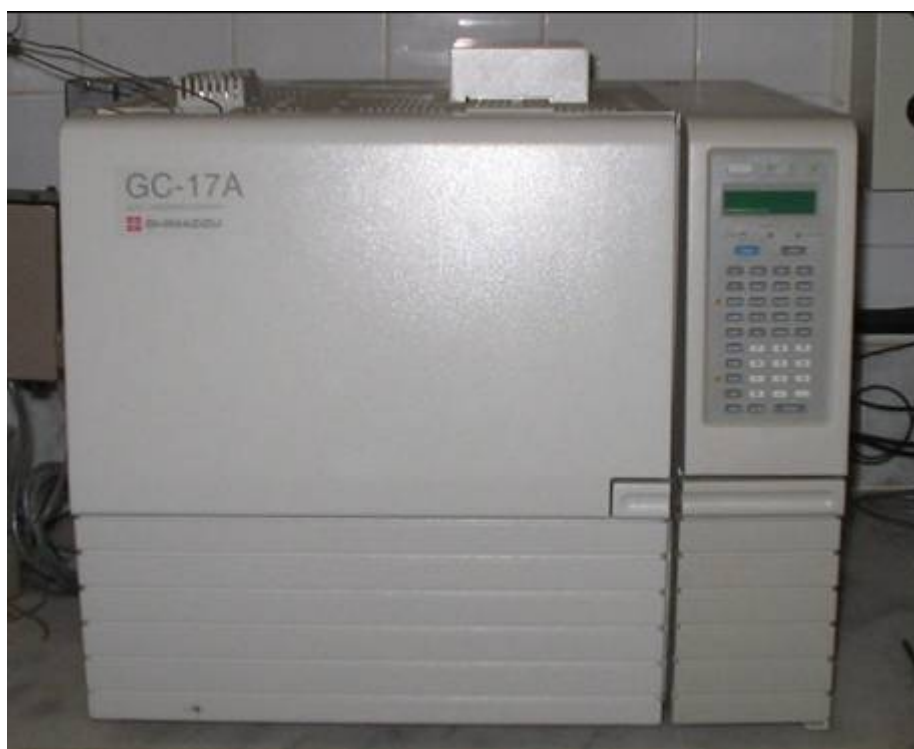
Figura C.3 - Foto do cromatógrafo da EQ - UFRJ utilizado no teste de atividade metanogênica do lodo anaeróbio do UASB
