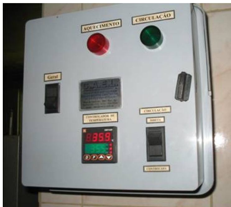
Figura C.2 - Foto do painel de controle da sala climatizada da EQ - UFRJ utilizada no teste de atividade metanogênica do lodo anaeróbico do UASB
