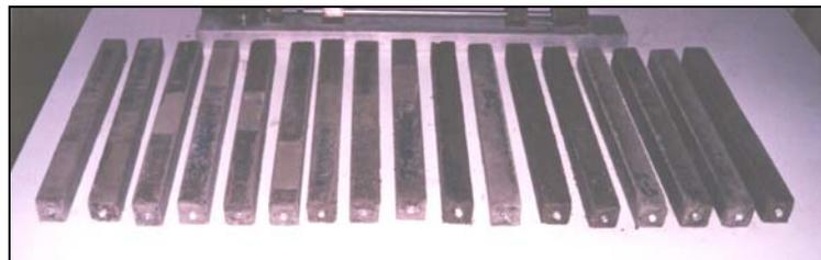
e) Aspecto dos corpos-de-prova após a desmoldagem
