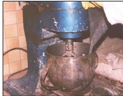
c) Mistura dos materiais: água; cimento; agregado
