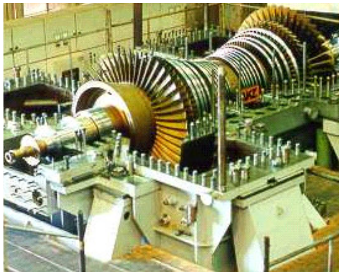
Figura 2.26 – Vista geral de uma turbina a vapor da Alstom Power.
