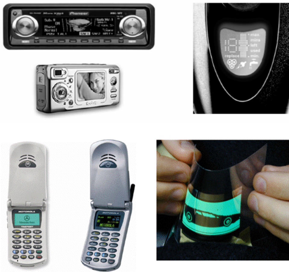
Fig. 1.6 – Exemplos de artefatos e produtos tecnológicos que apresentam painéis orgânicos embarcados. Versatilidade e baixo custo são características determinantes nas aplicações tecnológicas destacadas. No topo: à esquerda um auto-radio Pioneer com display de OLEDs; à direita, um barbeador elétrico da Philips , com display polimérico (pLEDs). No canto inferior esquerdo, dois aparelhos celulares da Motorola e, logo acima, uma câmera digital Kodak , todos equipados com visores orgânicos. No canto inferior direito, uma implementação artesanal de um painel orgânico, demonstrando a flexibilidade mecânica do dispositivo.
