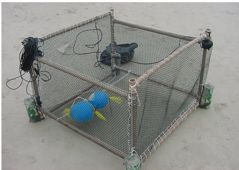
Figura 7. Gaiolas de 1m<sup>3</sup> utilizadas no experimento de exposição dos peixes aos disparos sísmicos.
