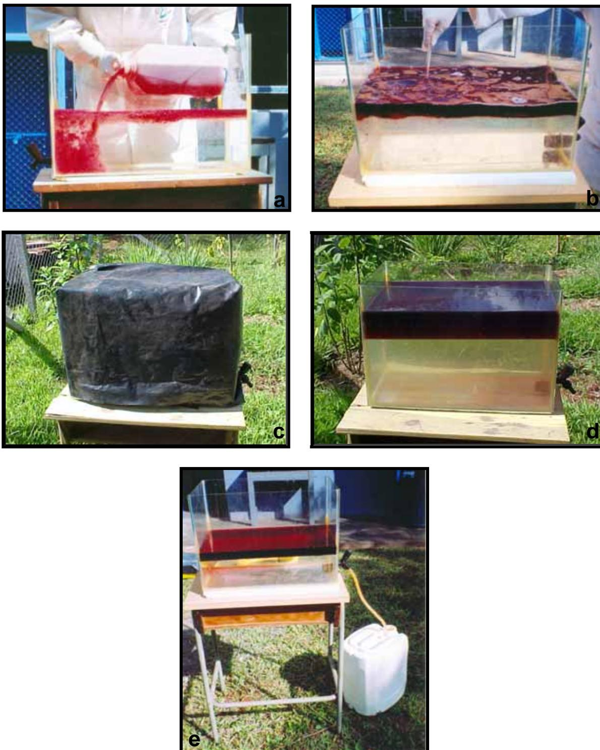
**FIGURA 2:** Simulação do derrame de óleo diesel (a – e); **a.** derrame do óleo em aquário de vidro de 50l; **b.** agitação; **c.** etapa de escuro (16 h); **d.** etapa de irradiação solar (6h); **e.** coleta da fração solúvel do diesel em água (FSD).
