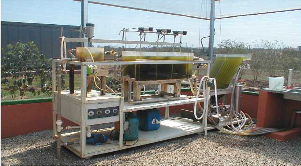
Figura 4.9: Sistema de tratamento físico-químico em série com o reator de lâmpada emersa de fluxo contínuo.
