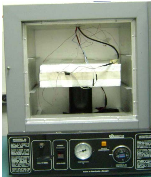
Figura 4.5 - Amostra de PVC disposta dentro do forno
