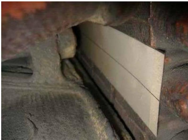
Figura 56 – Sensor capacitivo remanescente após período de fixação
