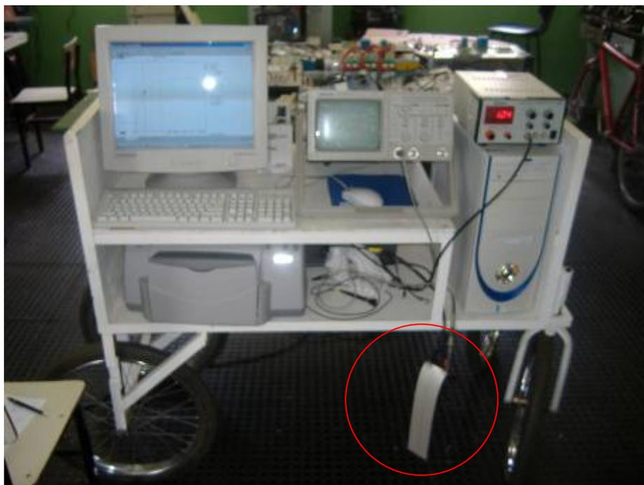
Figura 32 – Bancada de medições com capacitor suspenso no ar (em detalhe)
