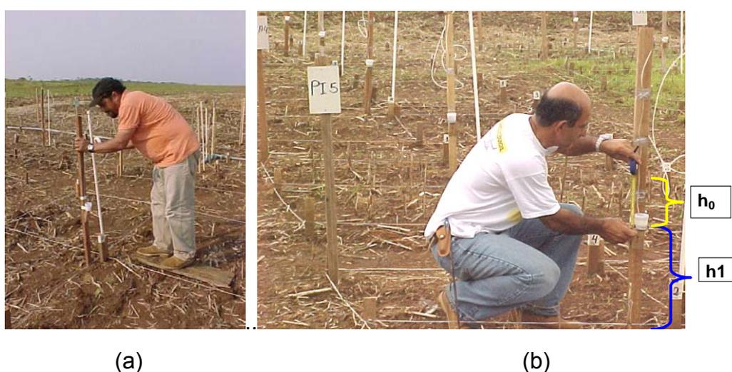
**Figura 5.** Leitura da coluna de Hg e instalação dos tensiômetros.
