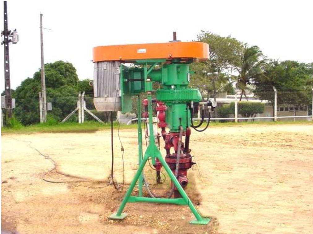
Figura 4.2: Poço com método de elevação artificial de bombeio por cavidades progressivas
