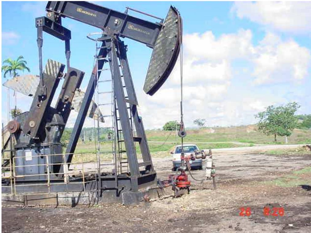
Figura 4.1: Poço com método de elevação artificial de bombeio mecânico com hastes
