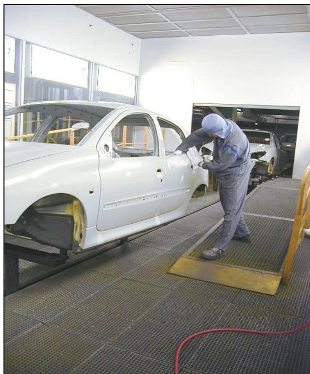
Figura 1.1 – Limpeza manual na cabine
