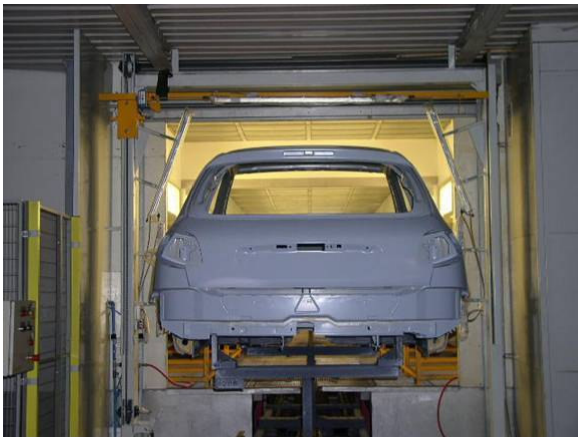
Figura 7.9 - Cortina de ar montada na entrada da cabine
