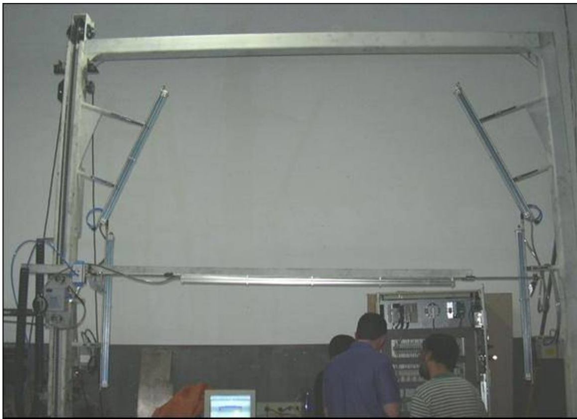
Figura 7.8 - Cortina de ar em fase de ensaios
