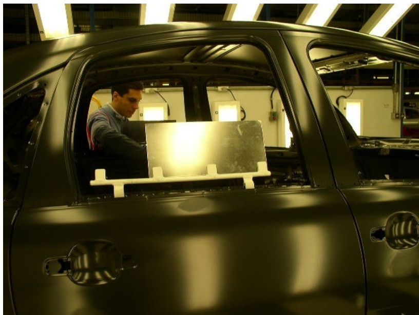
Figura 7.3 - Montagem da placa na carroceria
