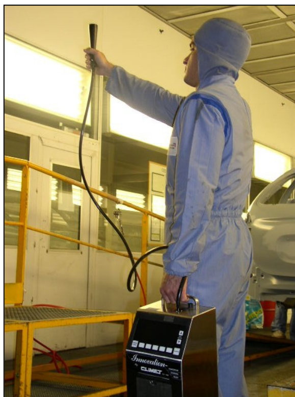
Figura 3.1 – Medição de partículas na cabine
