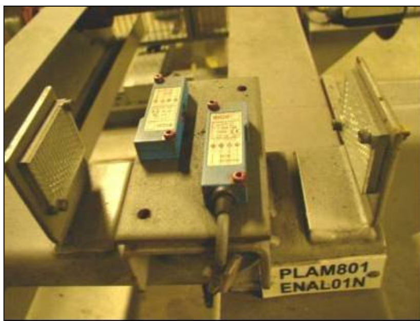
Figura 4.6 – Sensor óptico para leitura do código do transportador
