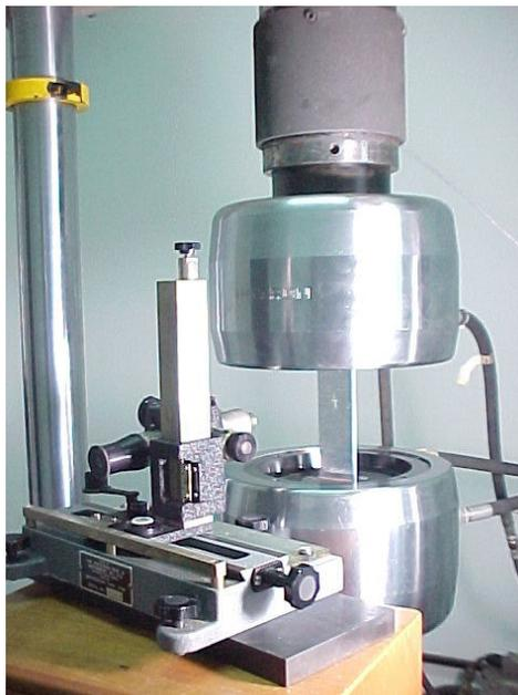
**Figura 3.6 - Montagem experimental para as medições do comprimento da trinca**
