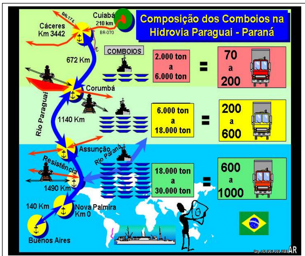
Figura 3: Composição dos comboios na hidrovia Paraguai Paraná e comparação com a capacidade do transporte rodoviário. (Fonte: Ahipar, 2004)
