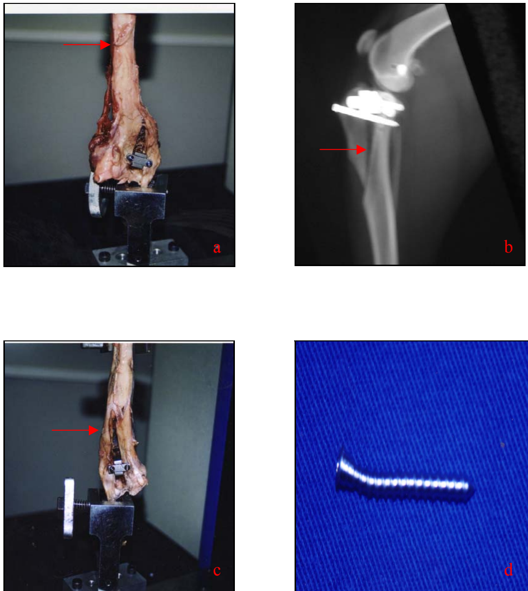
Figura 12 – (a) Fratura da diáfise tibial (seta) como mecanismo de falência no espécime 2. b) Imagem radiográfica do mesmo espécime após o emprego da técnica de TTA modificada, evidenciando osteotomia com posicionamento caudal (seta) em relação ao ideal. (c) Espécime 5, demonstrando como mecanismo de falência a avulsão da tuberosidade tibial em sua porção proximal (seta). (d) Parafuso estabilizador do espaçador na porção caudal com deformação plástica após emprego de carga máxima.
