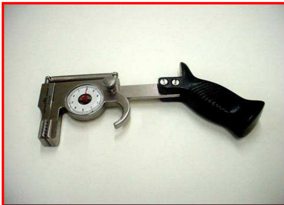
Figura 1 - Cutímetro de pressão com relógio aferidor da espessura da dobra pele, em milímetros (Hauptner)
