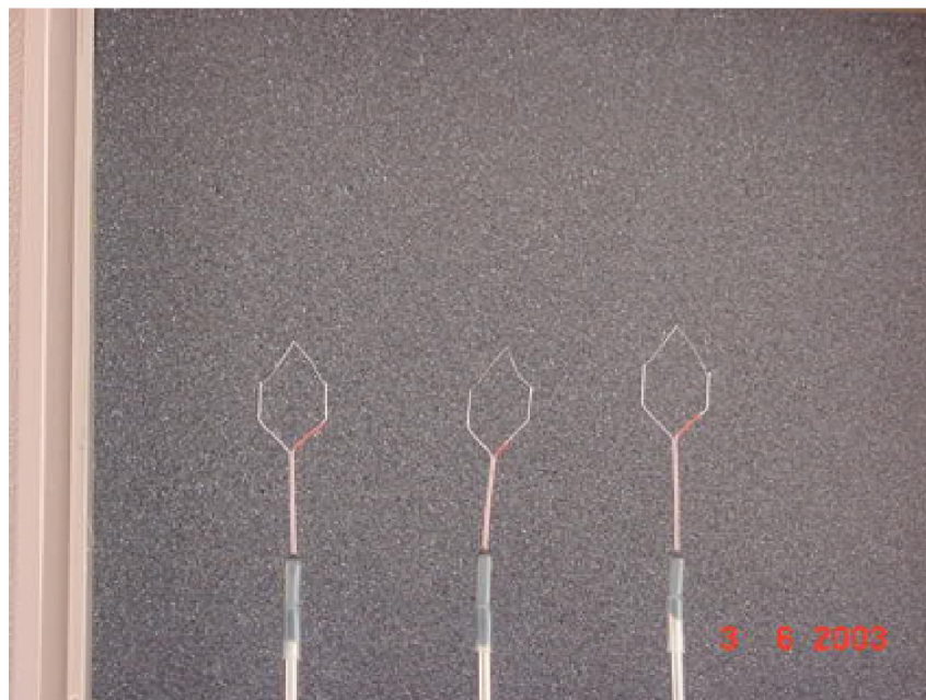
Figura 4.12: Equipamento de medição da temperatura do ar - termopar.
