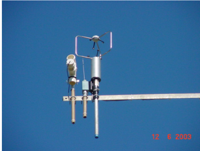
Figura 4.13: Sonda capacitiva CS500 , anemômetro sônico Young 81000 e termopar instalados na torre.
