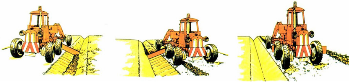
Figura 18-Correção de canaletas sujas nas laterais (PIARC, 1982)
