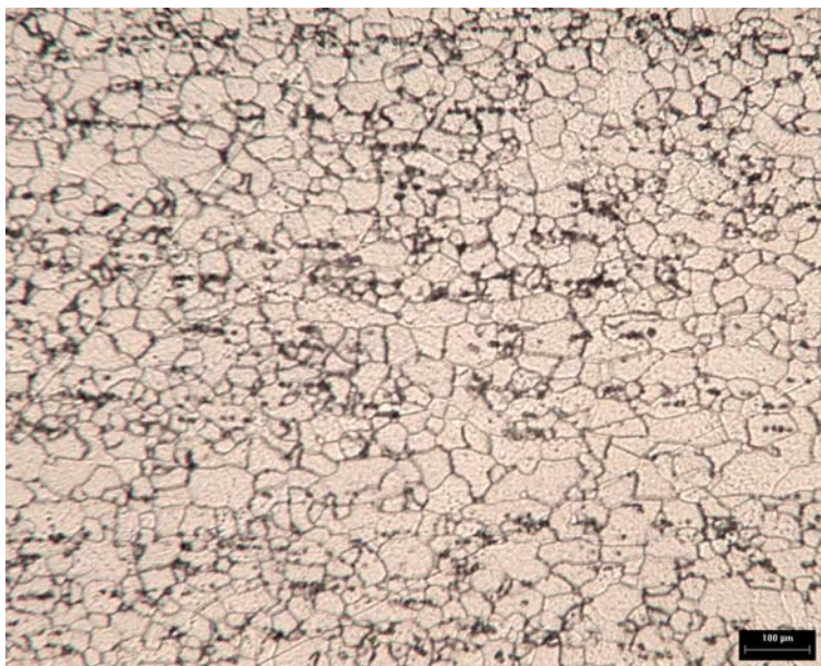
FIG. 4. 13 - Micrografia da seção longitudinal do material 430E recozido a 875°C. Aumento 200X. DL é horizontal.
