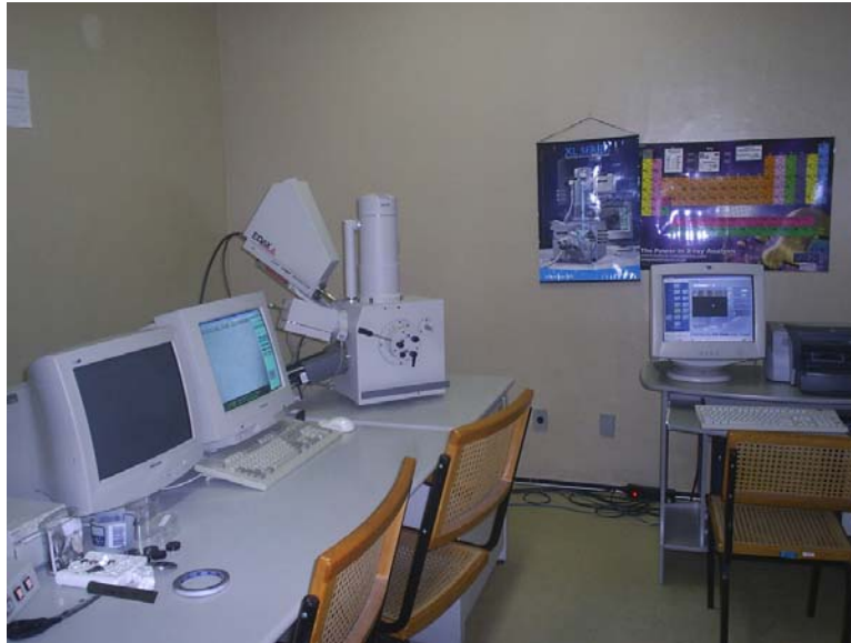
FIG.3. 6 – Equipamento utilizado para realização do EBSD.
