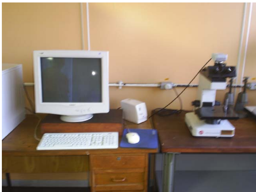
FIG.3. 3 – Microscópio Óptico e analisador de imagem “Image Pro-Plus”.
