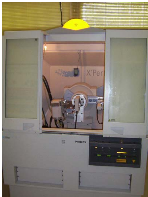
FIG.3. 4 – Difratorômetro Philips utilizado para análise da textura.
