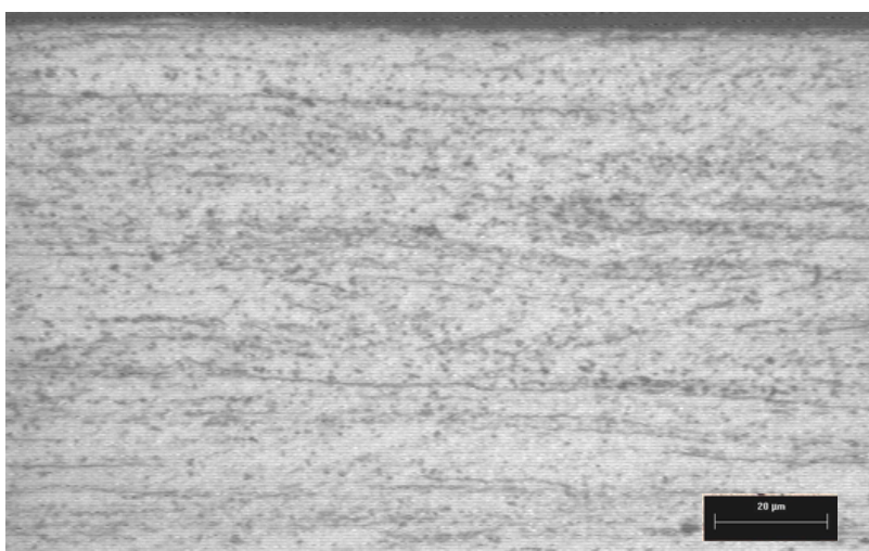
FIG. 4. 5 - Micrografia da seção longitudinal da amostra do aço 430A laminado 80% a frio. Aumento 200X. DL é horizontal.
