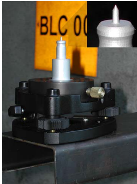
FIGURA 38 - ALVO PARA PONTARIA DE ÂNGULOS HORIZONTAIS
