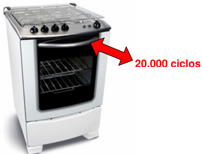
Figura 27: Teste de ciclagem de abertura e fechamento na porta do forno do produto
