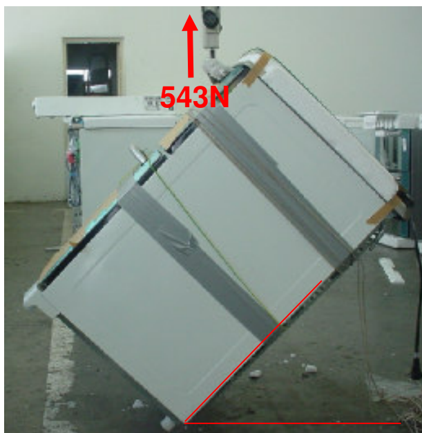
Figura 25: Suspensão parcial do produto pelo puxador. Nota-se que não há ruptura.
