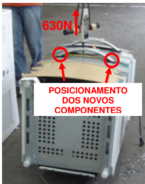
Figura 26: Completa suspensão do produto pelo puxador
