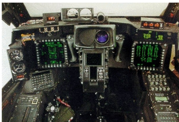
Figura 9: Painel do piloto do AH-64 Apache desmontado (em análise)
