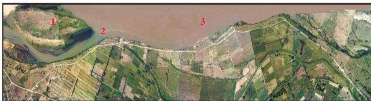
Figura 5.12: Mapa da linha de margem do rio São Francisco, trecho Própria-Neópolis: 2000 com destaque para (1) Ilha Major Cesário (2) tomada d'água pelo perímetro Cotinguiba-Pindoba (3) área de erosão mais acentuada Fonte: CODEVASF (2005)
