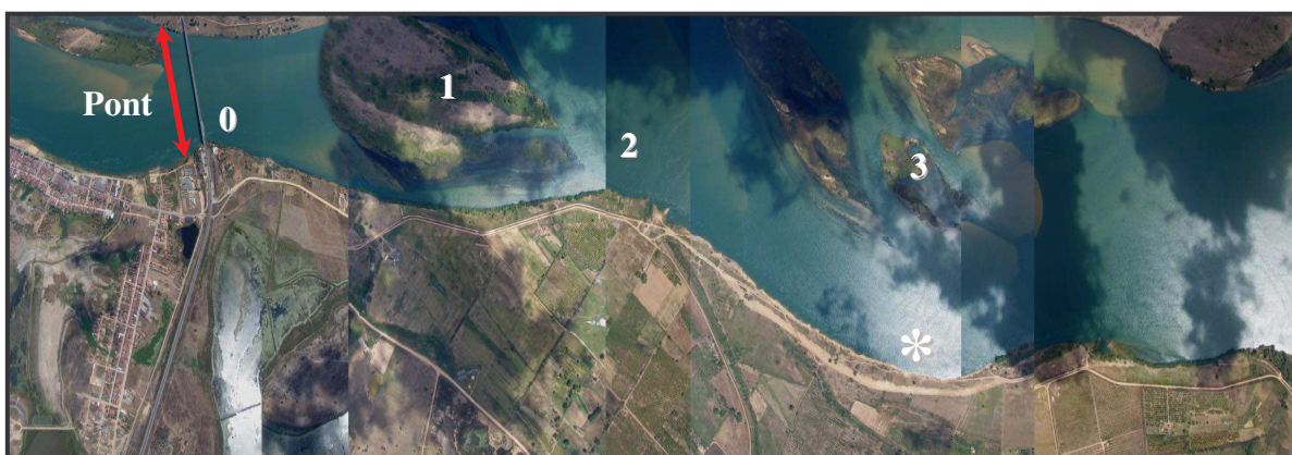
Figura 4.4: Fotomontagem da linha de margem do rio São Francisco, trecho Propriá-Neópolis ano de 2005, com destaque para (*) local de erosão mais acentuada e para os pontos 01 e 03 que equivalem respectivamente as Ilhas Major Cesário e Formosinho e 02 tomada d'água pelo perímetro Fonte: CODEVASF, 2005
