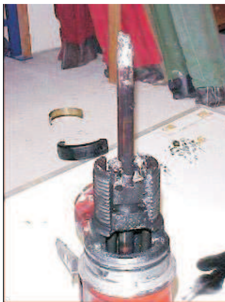
Figura 1.1: Pólo de um disjuntor PVO danificado. (Mamede 2004)
